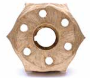
PRISE DE PILOTAGE USÉE
