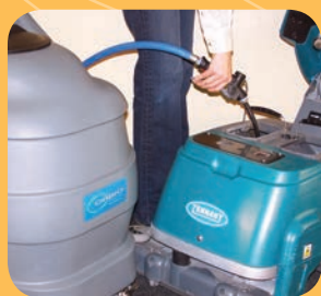
Riempimento rapido macchine
