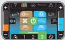
**Zone Settings™:** permite a los supervisores preconfigurar la máquina para limpiar zonas del edificio de forma individualizada
