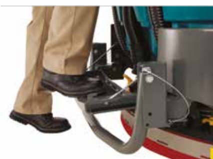
Marche d'accès au bac à eau sale
