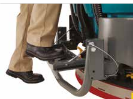
Degrau de acesso ao reservatório de recuperação
