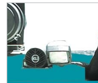
オーディオビジュアルバックアップアラーム 後退時にライトと音で周囲に知らせます。
