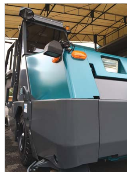
方向指示器+サイドスポットライト (右用) 事業所内におけるマシンの進行方向を周囲に知らせます。(*公道では使用不可です)
