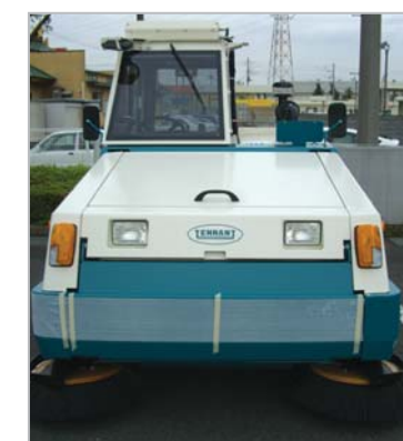
公道走行仕様 (大型特殊) 公道走行を行うにあたり、法規で規定された灯火器、転倒角対策を行います。
