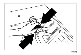
In: Push and hold the hopper rollout lever in the **In** position.
