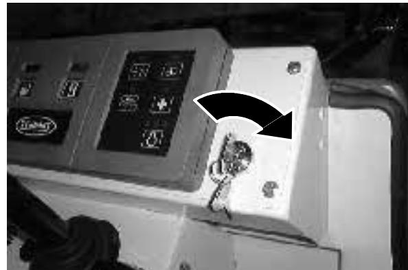
7. Επιλέξτε τις **Γρήγορες** στροφές του κινητήρα με το διακόπτη στροφών κινητήρα. (Για μηχανήματα με αριθμό σειράς κάτω του 006009).
