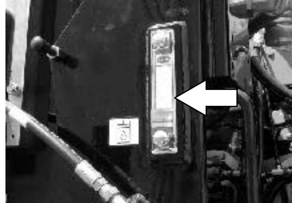
Αποστραγγίστε και ξαναγεμίστε το δοχείο υδραυλικού υγρού με νέο υδραυλικό υγρό μετά από κάθε 800 ώρες λειτουργίας.
