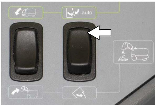
5. Izberite hitrost motorja. Uporabite srednjo hitrost za splošno pometanje in visoko hitrost za pometanje lažjih odpadkov.
