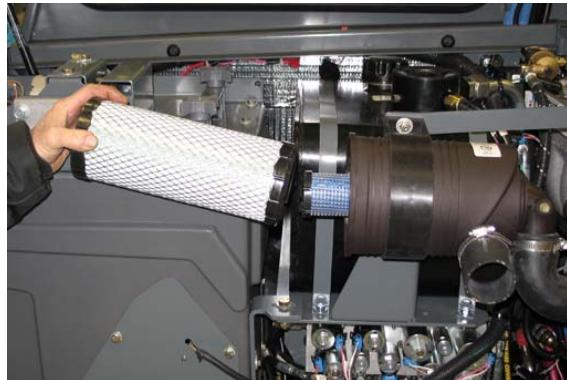
Po tretji menjavi primarnega filtra zamenjajte vložek varnostnega filtra. Ne odstranjujte vložka varnostnega filtra iz ohišja, razen če omejuje dotok zraka.
