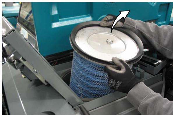
4. Očistite ali odvrzite filter za prah. Glejte ČIŠČENJE FILTRA ZA PRAH.
