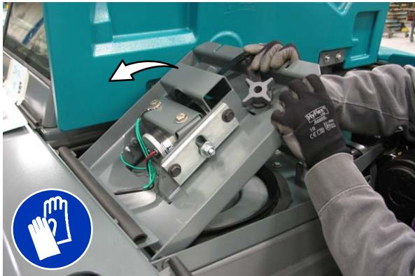
3. Odstranite filter za prah iz ohišja filtra.
