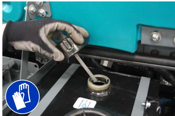
Na vrhu posode je čep za polnjenje. Ima vgrajen odzračevalnik in palico za merjenje ravni tekočine. Zamenjajte čep vsakih 800 ur dela.
