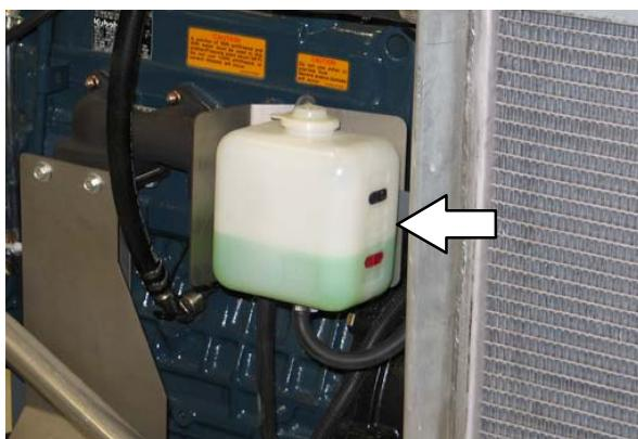
**VARNOSTNI NAPOTKI:** Ko vzdržujete stroj, ne odstranite pokrova s hladilnika, če je motor vroč. Počakajte, da se motor ohladi.
