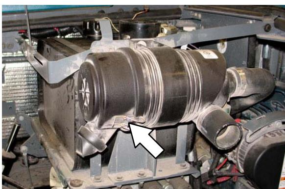
Odstranite vložek filtra. Z vlažno krpo previdno očistite pokrov in notranjost ohišja. Očistite tesnilne površine ohišja.
