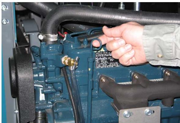
Polnite motor z oljem, dokler ni olje med dvema oznakama na merilni palici. NE napolnite prek zgornje oznake. Kapaciteta za motorno olje s filtrom za olje je 6 l.
