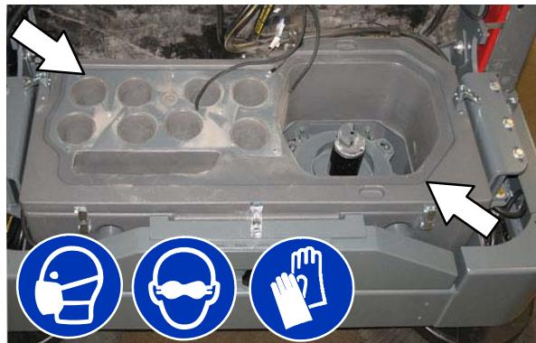
Odprite pokrov za dostop do ciklona, da odstranite prah in smeti iz pokrova ciklona.
