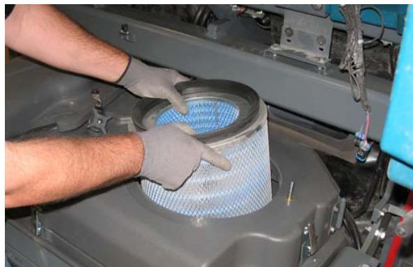
4. Očistite ali odvrzite filter za prah. Glejte ČIŠČENJE FILTRA ZA PRAH.
