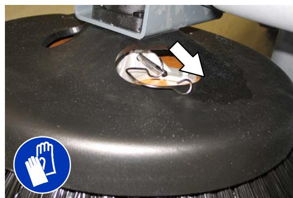
**OPOMBA:** Odstranite pesto pogona in ga namestite na novo krtačo, če še ni nameščena.
