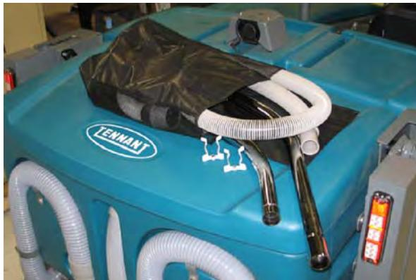
2. Συνδέστε το σωλήνα αναρρόφησης στον εύκαμπτο σωλήνα αναρρόφησης.
