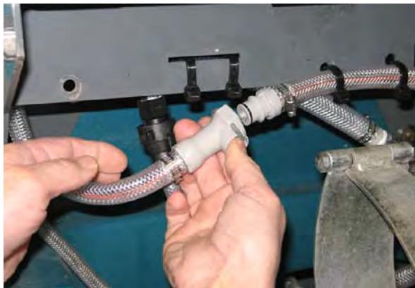
4. Τραβήξτε το σωλήνα αποστράγγισης από ανάμεσα στη μονάδα ec-H2O και το διαμέρισμα του χειριστή, αφαιρέστε την τάπα από το σωλήνα και τοποθετήστε το άκρο του σωλήνα σε ένα άδειο δοχείο. Τοποθετήστε την τάπα στην άκρη.
