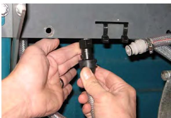
5. Τοποθετήστε το σωλήνα παροχής του συστήματος ec-H2O σε ένα δοχείο που περιέχει περιέχει 19 λίτρα λευκό ξύδι ή ξύδι από ρύζι. Τοποθετήστε το σωλήνα εξόδου σε ένα άδειο δοχείο.
