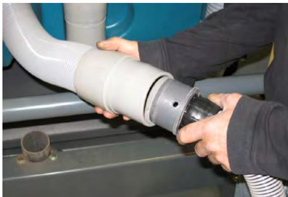
3. Συναρμολογήστε το ακροφύσιο και το σωλήνα.
