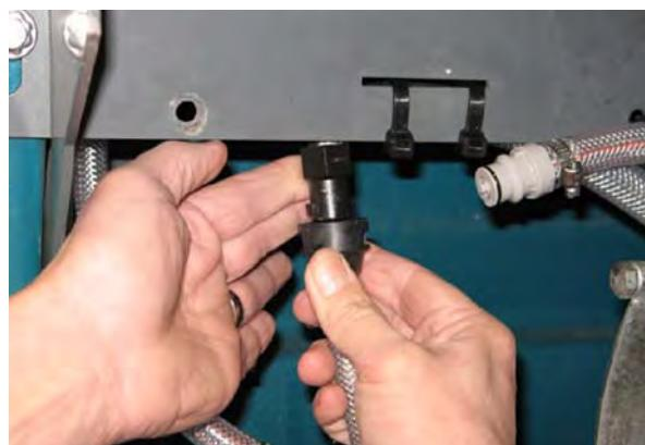
9. Φυσήξτε πεπιεσμένο αέρα (λιγότερα από 344 kPa (50 psi)) στο σωλήνα εξόδου του συστήματος ec-H2O. Συνεχίστε να φυσάτε πεπιεσμένο αέρα στο σωλήνα εξόδου μέχρι να μην αποστραγγίζεται πλέον νερό από το σωλήνα αποστράγγισης.
