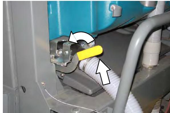
9. Επανατοποθετήστε το σωλήνα αποστράγγισης του κάδου ακάθαρτου υγρού στο πίσω μέρος του κάδου.
