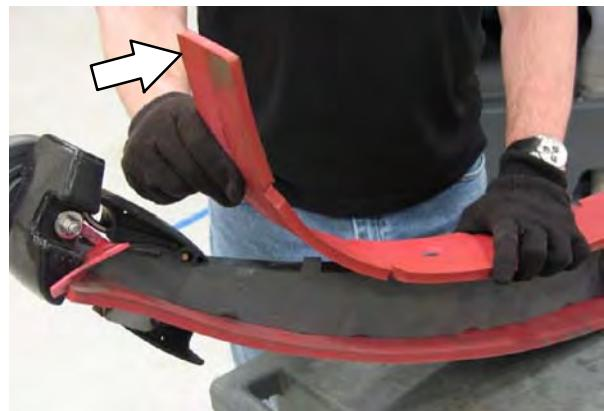
13. Τοποθετήστε τη νέα μπροστινή λεπίδα του μάκτρου ή περιστρέψτε την υπάρχουσα λεπίδα για να χρησιμοποιήσετε καινούρια ακμή. Βεβαιωθείτε ότι οι προεξοχές του σφιγκτήρα της λεπίδας ελαστικού μάκτρου εφαρμόζουν στις οπές.
