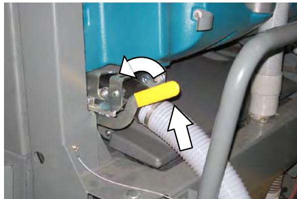
10. Επανατοποθετήστε το σωλήνα αποστράγγισης κάδου ακάθαρτου υγρού στο πίσω μέρος του κάδου και κλείστε το κάλυμμα του κάδου ακάθαρτου υγρού.
