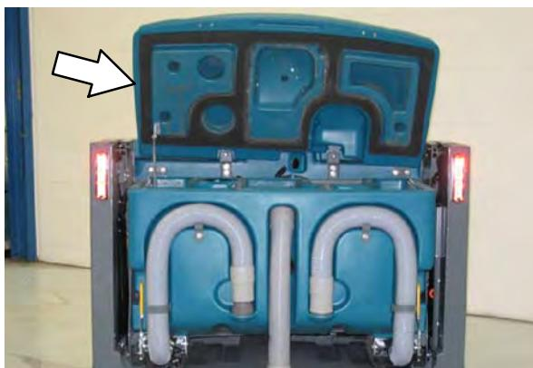
2. Τοποθετήστε το σωλήνα αποστράγγισης του κάδου ακάθαρτου υγρού δίπλα στην αποχέτευση δαπέδου.
