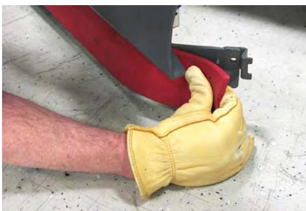
7. Επανατοποθετήστε στη θέση τη λάμα συγκράτησης του πλευρικού ελαστικού μάκτρου.
