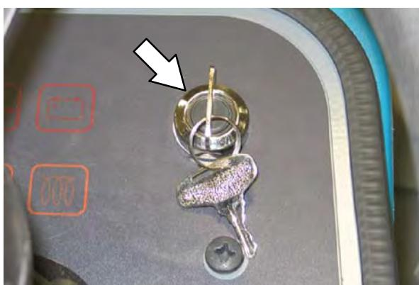
**ΣΗΜΕΙΩΣΗ:** Μη χρησιμοποιείτε τη μίζα για περισσότερο από 10 δευτερόλεπτα κάθε φορά ή μετά την εκκίνηση του κινητήρα. Αφήστε τη μίζα να κριώσει 15-20 δευτερόλεπτα ανάμεσα σε προσπάθειες εκκίνησης, διαφορετικά μπορεί να προκληθεί βλάβη στη μίζα.
