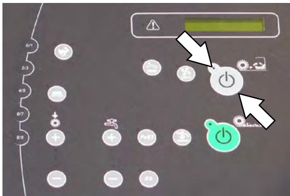
**ΣΗΜΕΙΩΣΗ:** Ο δονητής φίλτρων ανακινεί αυτόματα το φίλτρο για σύντομο διάστημα κάθε φορά που το πλήκτρο σκουπίσματος 1-STEP απενεργοποιείται.
