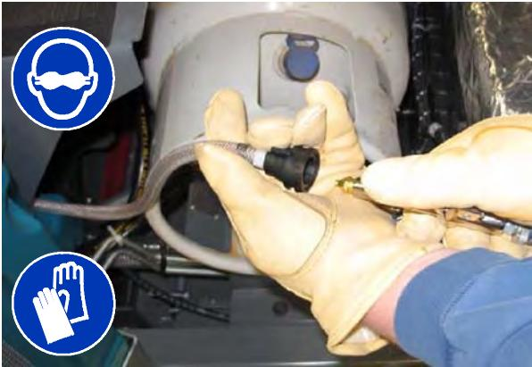
10. Επανατοποθετήστε την τάπα στο σωλήνα αποστράγγισης και τοποθετήστε το σωλήνα πίσω στη μονάδα ec-H2O και το διαμέρισμα χειριστή.
