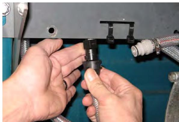
4. Τοποθετήστε το σωλήνα εξόδου του συστήματος ec-H2O σε ένα άδειο δοχείο.
