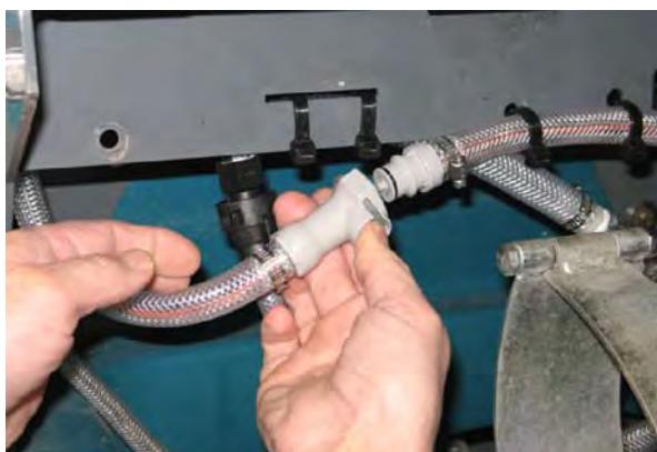
4. Αποσυνδέστε το σωλήνα εξόδου του συστήματος ec-H2O από το σωλήνα στην κεφαλή καθαρισμού και συνδέστε το σωλήνα εξόδου πλυσίματος (μαύρος συνδετήρας) στο σωλήνα εξόδου του συστήματος ec-H2O.
