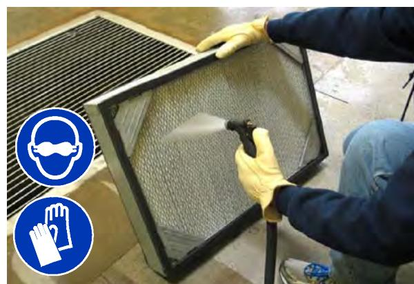
**ΣΗΜΕΙΩΣΗ:** Αν χρησιμοποιείτε νερό για να καθαρίσετε το φίλτρο σκόνης, βεβαιωθείτε ότι το φίλτρο είναι εντελώς στεγνό πριν το επανατοποθετήσετε μέσα στη χοάνη. **Μην επανατοποθετείτε το υγρό φίλτρο σκόνης.**
