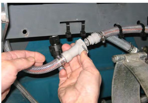
4. Trageți tubul de drenare dintre unitatea ec-H2O și compartimentul operator, îndepărtați capacul de la tub și punteți capătul tubului într-un container gol. Puneți capacul la o parte.
