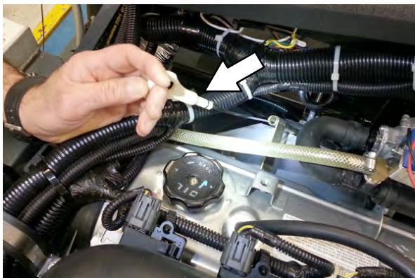
Umpleți motorul cu ulei până când uleiul se află între marcajele indicatoare de pe tija de nivel. NU umpleți peste marcajul indicator superior.
