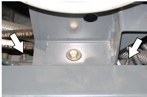
De cealaltă parte a mașinii, gresoarele cu bilă ale tuburilor de torsiune sunt amplasate sub pompa propulsoare.
