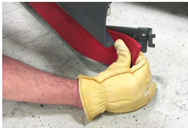
7. Montați la loc banda de reținere a racletei laterale pe ansamblul racletei laterale.
