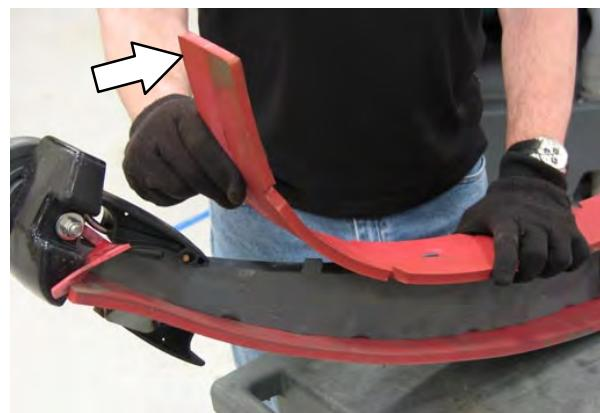
13. Montați noua lamă a racletei din față sau roțiți lama existentă la muchia nouă.
