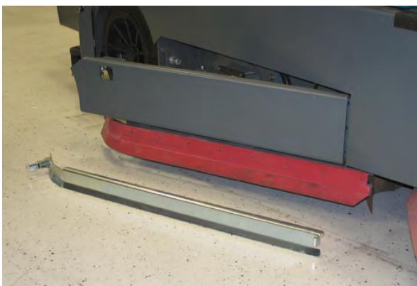
5. Extragăti lama racletei laterale. Dacă muchia externă a lamei racletei nu este uzată, schimbați lama racletei cu lama din partea opusă a mașinii. Eliminați lama racletei dacă ambele muchii sunt uzate.
