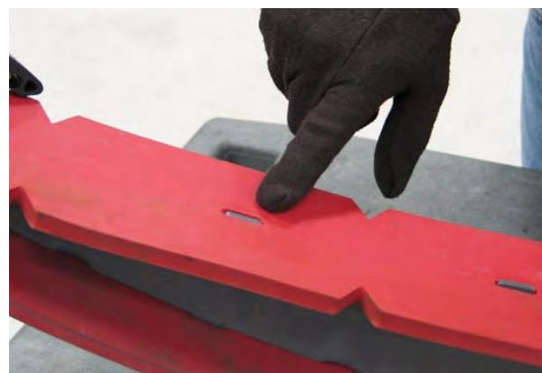
14. Montați din nou banda de reținere din față aliniind agățătorile cu orificiile.
