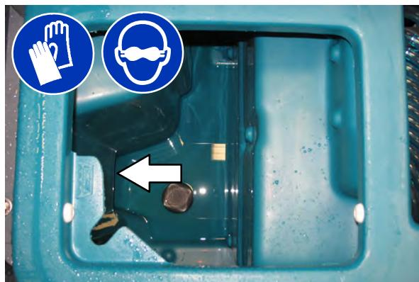
5. Clătiți senzorul cu flotor și filtrul cu sită. Lăsați rezervorul de soluție să se scurgă.
