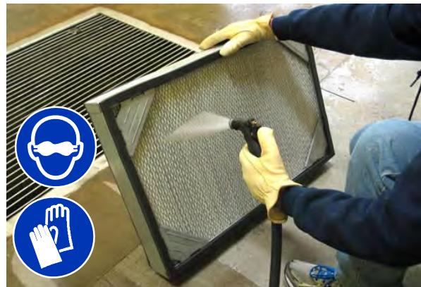
**NOTĂ:** *Dacă folosiți apă pentru a curăta filtrul de praf, asigurați-vă că filtrul este uscat complet înainte de remontarea acestuia în sită. **NU remontați** un filtru de praf umed.*
