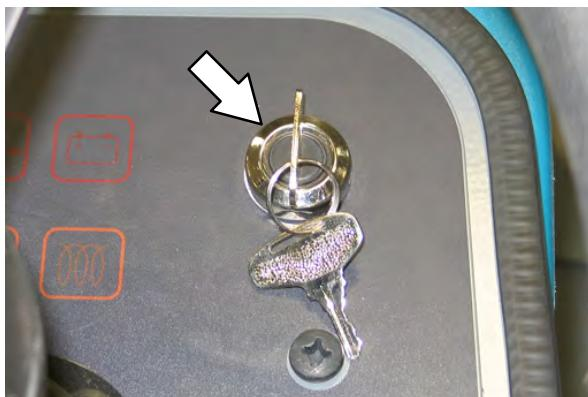
**NOTĂ:** Nu utilizaţi motorul de pornire pentru mai mult de 10 secunde odată sau după ce motorul a pornit. Lăsaţi motorul de pornire să se răcească timp de 15-20 secunde între încercările de pornire sau este posibilă producerea deteriorării motorului de pornire.
