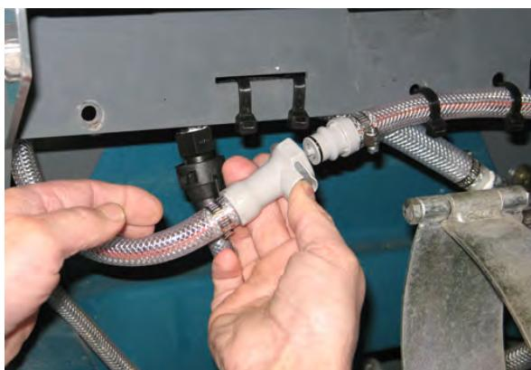
4. Deconectați furtunul de evacuare al sistemului ec-H2O de la capul de frecare și conectați furtunul de evacuare clătire (conectorul negru) la furtunul de evacuare al sistemului ec-H2O.
