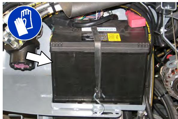
**PENTRU SIGURANȚĂ:** Când reparați mașina, evitați contactul cu acidul bateriilor.
