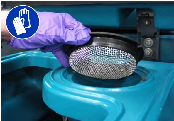
6. Clătiți senzorul cu flotor.
