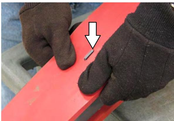
9. Montați din nou banda de reținere din spate aliniind agățătorile cu orificiile.
