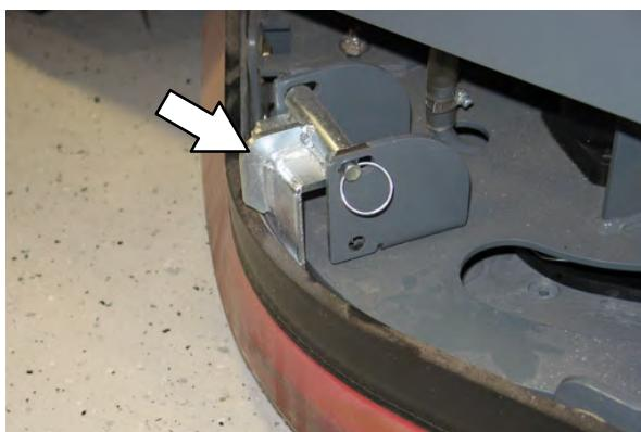
Opțiunea perie laterală (S/N 001279– ): Înainte de curățarea dublă, îndepărtați amortizorul periei laterale. Trageți știfturile și îndepărtați amortizorul racletei.
