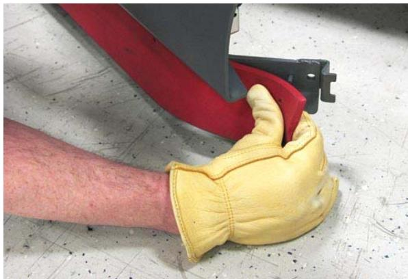
7. 重新将吸水扒固定带连接到边吸水扒组件上。
