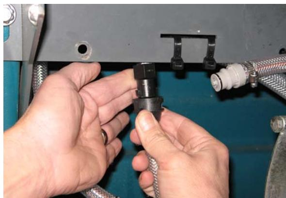
9. 将加压空气（低于 344 kPa (50 psi)）送入 *ec-H2O* 系统排气软管。继续将加压空气送入排气软管，直到水不再从排水管中排出。
