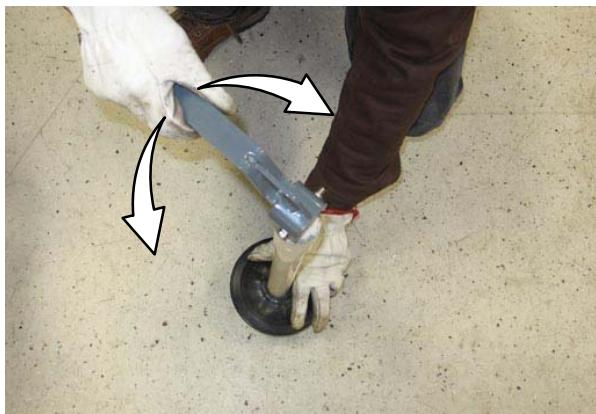
8. 关闭污水箱的可调节排水阀 (Variable Drain Valve)。
