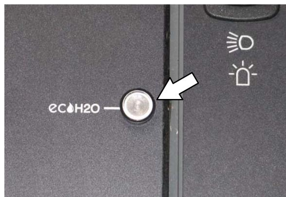
注意: 当发警报声并且指示灯闪烁红色时, 机器将绕过 ec-H2O 系统。要继续洗地, 请按 ec-H2O 按钮关闭 ec-H2O 系统。
