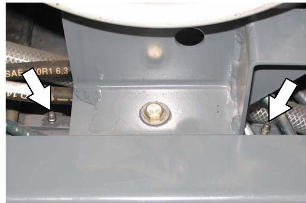
机器另一侧的扭矩管润滑油嘴位于驱动泵下方。
