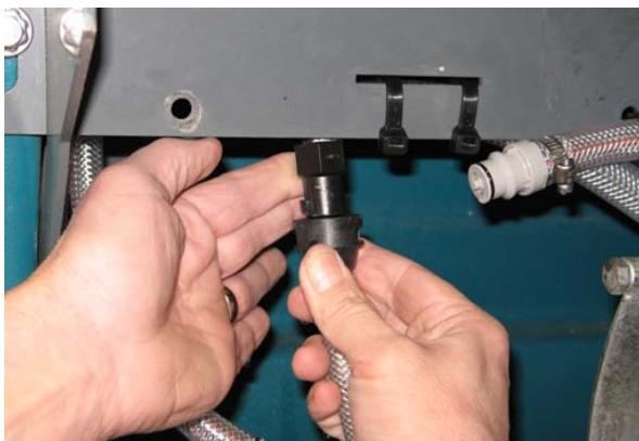
5. 将 ec-H2O 系统进气软管放入含有 5 加仑（19 升）白醋或米醋的容器。将排气软管放入空容器中。
