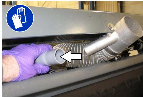
9. 漂洗垃圾箱过滤网和垃圾箱中的灰尘和残渣。
