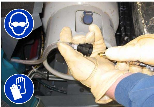
10. 将管帽重新安装到排水管上，将管道插入 *ec-H2O* 组件和操作员室之间。
