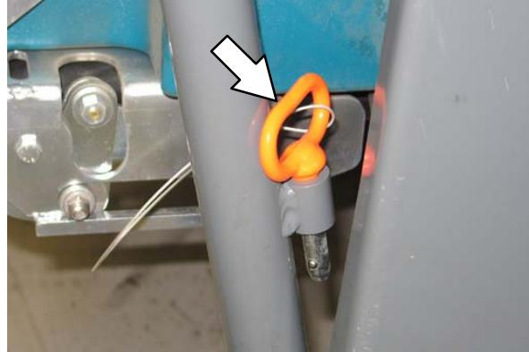
5. 将垃圾箱支撑销插入三个垃圾箱支撑孔中的一孔。降低垃圾箱直到它搁置在支撑销上。
