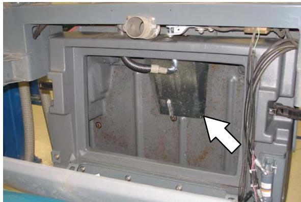
10. 重新安装垃圾箱灰尘过滤网。参见本手册中的拆除洗垃圾箱灰尘过滤网一节。
