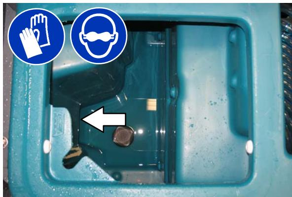
7. 重新安装清水箱排水管到污水箱后部。
