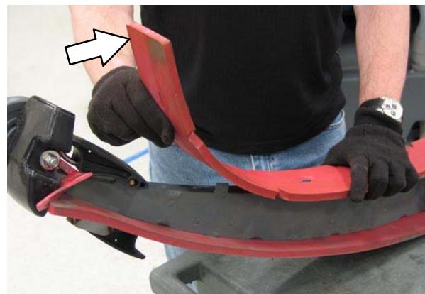
13. 安装新的前吸水扒胶条，或旋转现有胶条以□用一个新的边缘。确保吸水扒胶条上的所有孔均与金属片牢固钩住。
