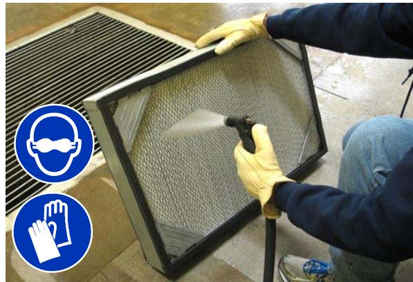
**注意：**如果使用清水清洗灰尘过滤网，那么将过滤器重新安装到垃圾箱内前，确保过滤器已完全干透。不要 将潮湿的灰尘过滤网安装到机器内。
