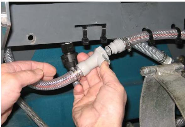
4. 将 ec-H2O 系统排气软管与擦洗头断开，将排气冲洗软管（黑色连接器）连接到 ec-H2O 系统排气软管。
