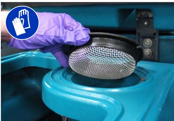
8. 朝污水箱排水管方向漂洗灰尘和残渣。
