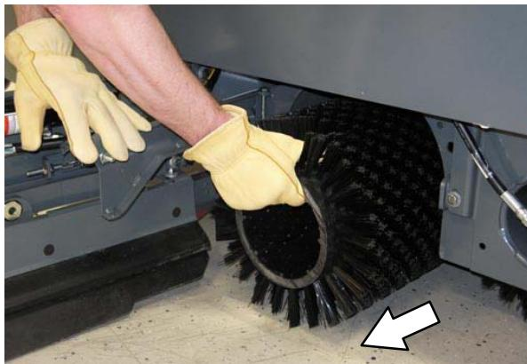
6. 按住刷子尾端向下推，同时将其滑入传动马达轴中，以此来安装新的或经过旋转的刷子。
