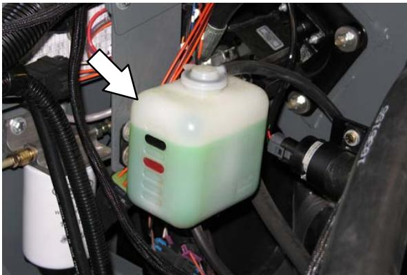
每工作 800 小时冲洗一次散热器和冷却系统。
