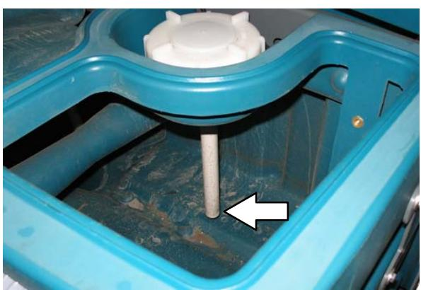
9. 关闭污水箱的可调节排水阀 (Variable Drain Valve)。
