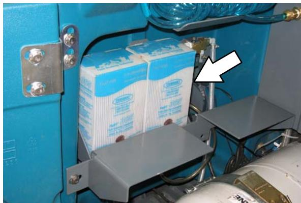
在选配件 ES（延长洗地）模式下时，通过 ES 系统过滤污水箱中的脏水，过滤后的清水再回到清水箱中再次利用。然后将清洁剂注入过滤后的清水中以恢复清水的清洁功能。
