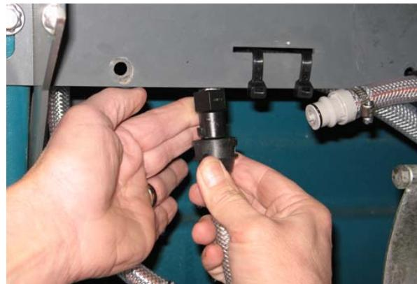
4. 将 *ec-H2O* 系统排气软管放入一个空容器中。
