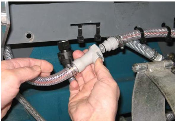
4. 在 ec-H2O 装置和操作员室之间拉动排水管，取下管帽，将管帽放入空容器中。将管帽放在一边。
