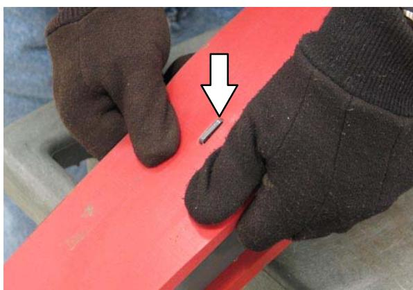
9. 重新安装后部固定带，并将金属片与孔对齐。
