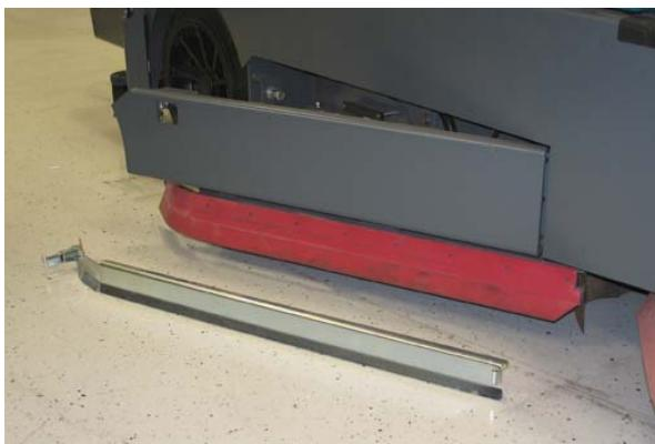
5. 取下吸水扒胶条。如果吸水扒胶条的外部边缘未磨损，那么从机器的另一侧旋转吸水扒胶条。如果两边均已磨损，那么丢弃胶条。
