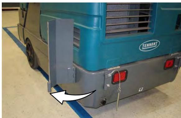
3. 操作机器前关闭并紧固塔式减震器。
