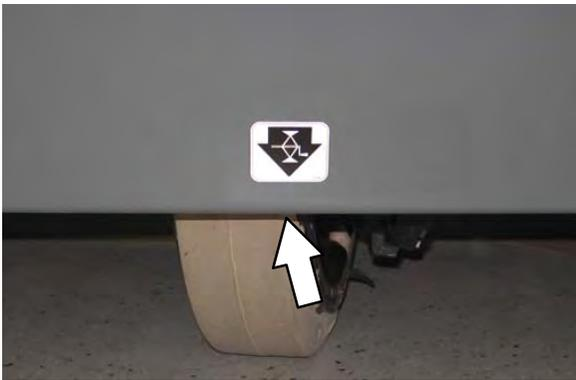
前顶起位置直接定位在前轮胎前部的机架上。
