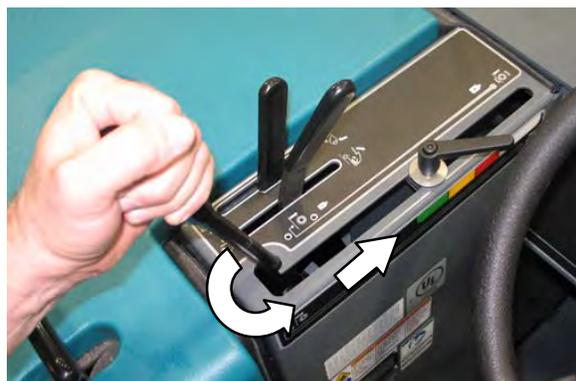
5. 将边刷杆放在左边刷向下和打开位置。刷将自动开始旋转。
