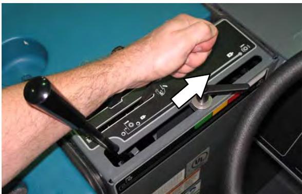
12. 将真空和过滤网振动器杆移动到真空风扇打开位置。
