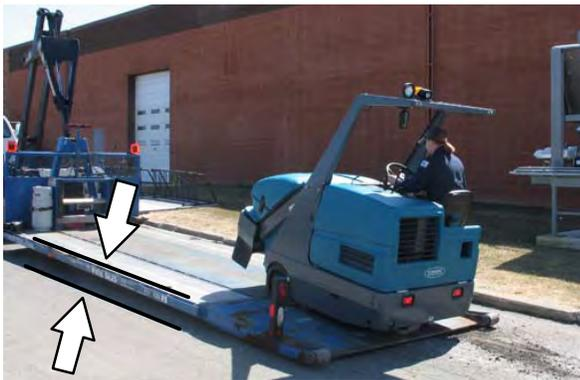
3. 要将机器用绞车提到卡车或拖车中，在后部系一条绞车链。后部系紧位置是机器两侧的洞，靠近后部保险杠。
