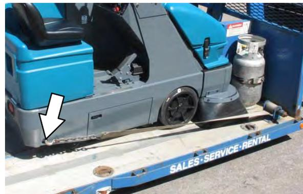
6. 如果装载面不水平，或者离地大于 380 毫米 (15 英寸)，那么使用绞车来卸载机器。
