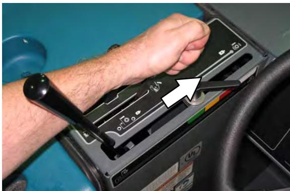
3. 将真空和过滤网振动器杆移动到真空风扇打开位置。
