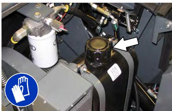
油箱的顶部装有带过滤网盖。过滤网盖内置通气阀和液位量油计。每工作 800 小时更换一次过滤网盖。
