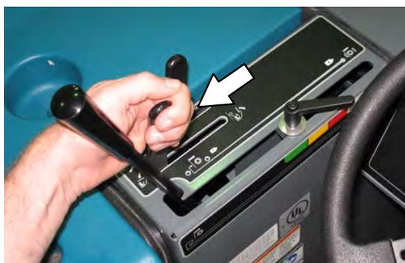
10. 将真空和过滤网振动器杆移动到真空风扇打开位置。
