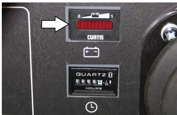
电瓶放完电后，最右边的指示器亮。随着电瓶不断放电，指示器会随显示器移动到左边。指示器闪烁时，再次对电瓶充电。
