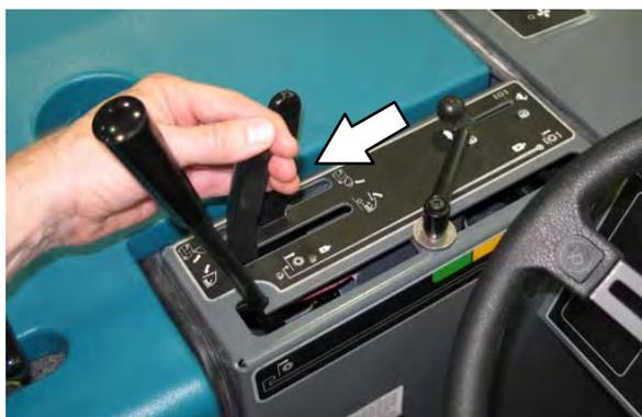
4. 将真空和过滤网振动器杆保持在过滤网振动器位置 30 秒，振动灰尘过滤网。
