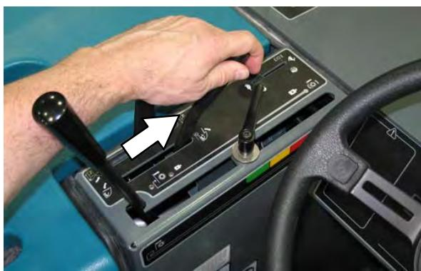
4. Придвижете лоста за управление на вакуумната помпа и вибрационното сито на филтъра до позиция **Вакуумна помпа включена**.
