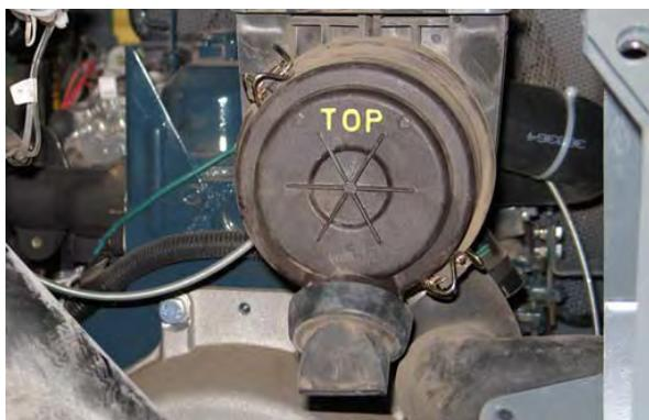
След като смените елемента на въздушния филтър, натиснете бутона за възстановяване в края на индикатора, за да възстановите индикатора.
