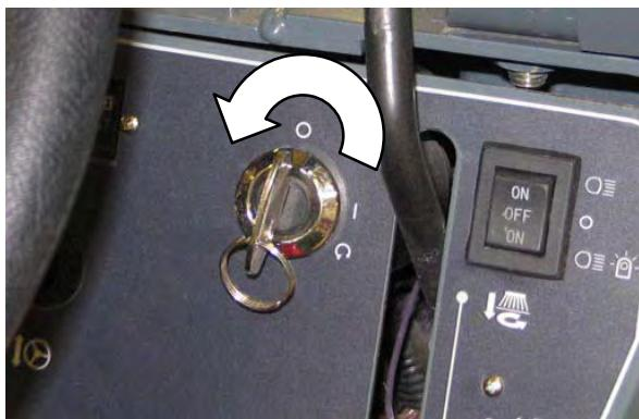
**ЗА БЕЗОПАСНОСТ:** Преди напускане или обслужване на машината, не паркирайте в близост до горими материали, прах, газове или течности. Спрете на равна повърхност, активирайте паркинг спирачката, изключете машината и извадете ключа.
