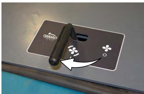
**ЗАБЕЛЕЖКА:** Каналът на вакуумната помпа трябва да бъде затворен при измитане на влажни отпадъци.
