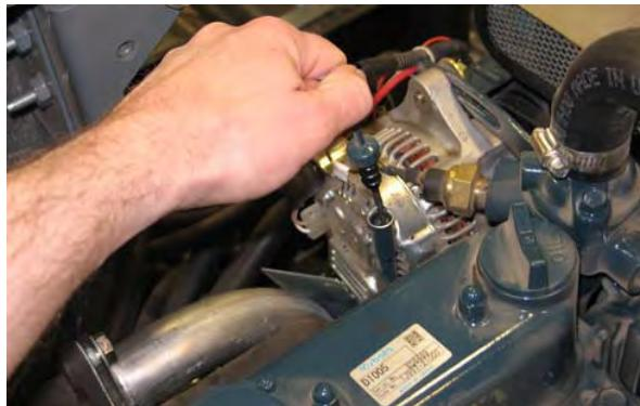
Зареждайте двигателя с масло, докато то достигне ограничителната маркировка на указателя на нивото. НЕ наливайте след достигане на последната ограничителна линия на указателя за ниво. Вместимостта на моторното масло е 5,1 L (5,4 l) с маслен филтър.
