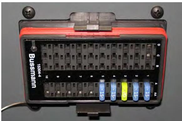
Вижте таблицата по-долу за разположение на предпазителите и релетата на релейния панел.
