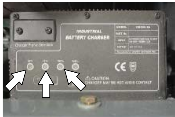
WSKAZANIE STANU ŁADOWANIA PRZEZ DIODY LED
