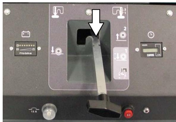
Poloha spustenia hlavnej kefy: (Hladké, rovné podlahy) Potlačte páku dole, potom ju potiahnite dozadu a zaistite hornú západku páky v polohe spustenia hlavnej kefy.
