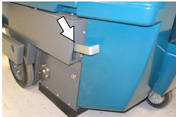
Pre uvoľnenie parkovacej brzdy stúpnite na páku a uvoľnite ju do krátkej západky vpravo.
