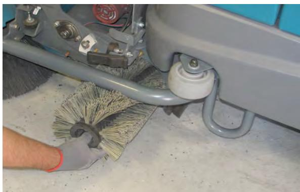
8. 在驱动轮轴上引导新刷子的有槽端。
