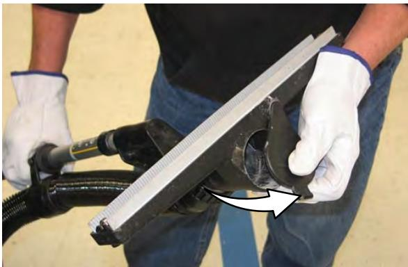
10. 将真空吸扒/吸水扒真空软管重新安装在后吸水扒上。
