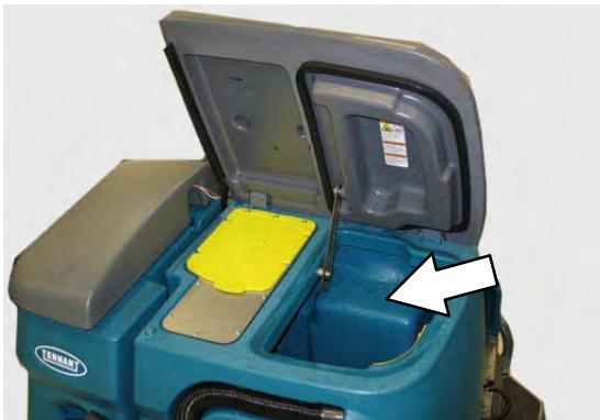
4. 在污水箱中注入水（温度不超过 60° C / 140° F）。加注污水箱刚好至加注污水箱刚好至 ES 加注污水箱刚好至 ES 过滤器顶部。盖上污水箱盖。
