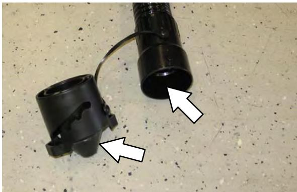
7. 扭动排水管口关闭，将排水管钩回清水箱上。
