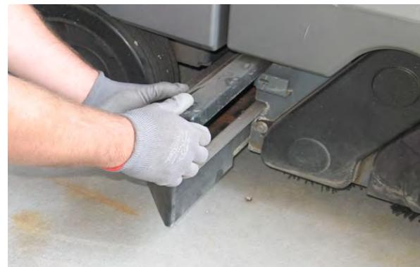
**注意:** 洗地头必须降低约 25 mm (1 in) 才能取下残渣槽。
