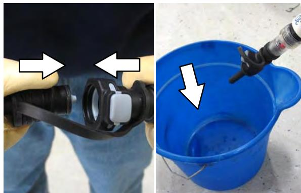
4. 取下电瓶注水管上的防尘罩，并连接加注调节器。
