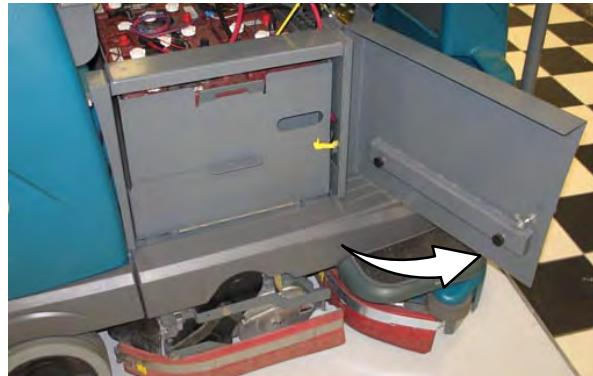
3. 将电瓶上的机器接头断开。
