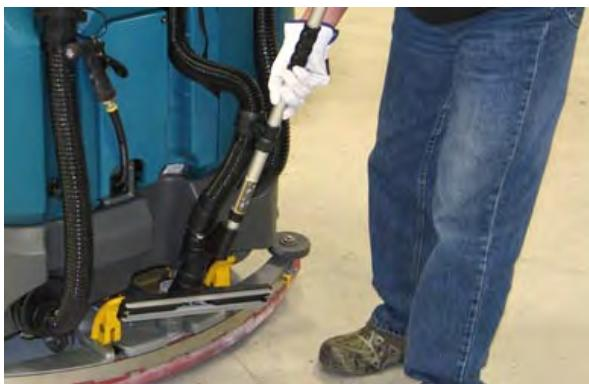
3. 将真空吸扒帽插入真空吸扒的真空口中。
