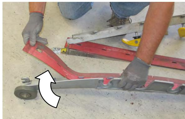
10. 将旋转的或新吸水扒胶条安装在外机架中。确保吸水扒完全滑在外机架的每个金属片上。
