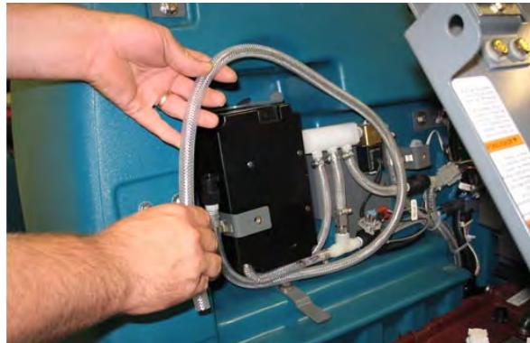
4. 将出水软管从与 ec-H2O 总管连接的软管上断开。
