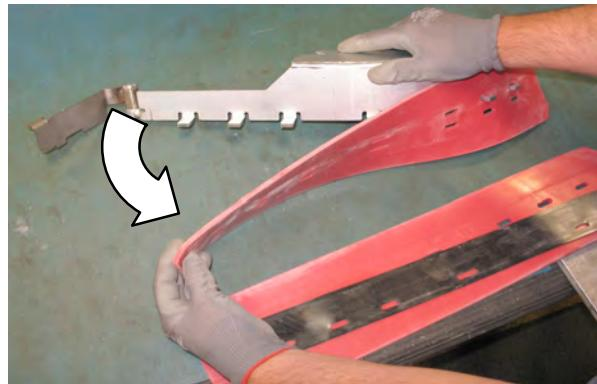
注意：吸水扒胶条有两组槽，用于调整吸水扒胶条的弧度。安装/重新安装吸水扒使清洗光滑地面时的弧度为 12 mm (0.50 in.)，清洗粗糙地面时的弧度为 15 mm (0.62 in.)。
