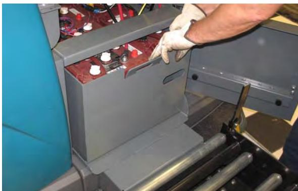
9. 向上拉把手降低车电瓶挡杆。这样将防止电瓶滚落车。
