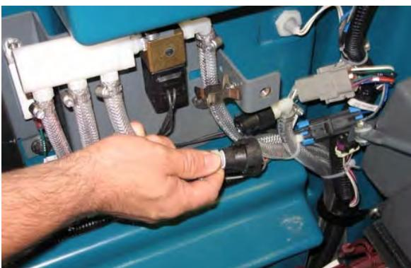
9. 将排水管连接到上一步中与排气软管断开的 ec-H2O 总管。
