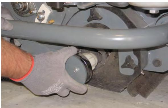
5. 取下将预先清扫边裙边和边裙边板固定在预先清扫组件上的三个旋钮。
