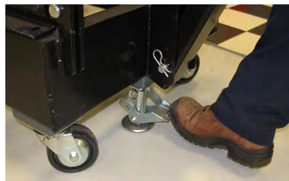
7. 如果需要，调整电瓶车滚轴的高度。电瓶车滚轴必须与机器电瓶滚轴平齐。调整电瓶车两侧高度。
