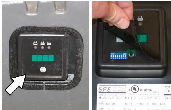
将转换器调整为电瓶的正确设置。
