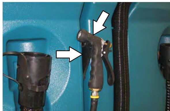
6. 按下喷嘴开关的底部关闭水源。喷嘴关闭时，此开关上的灯将会熄灭。
