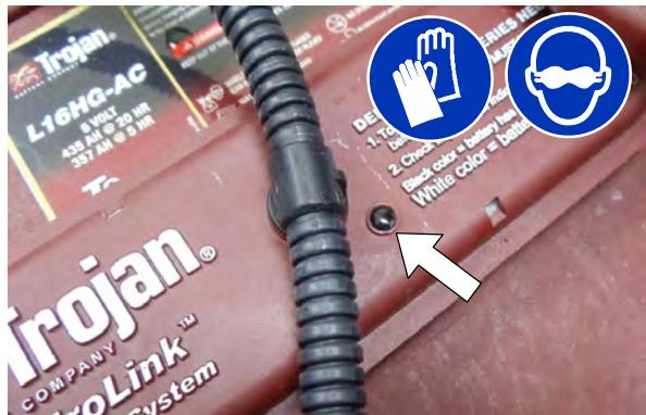
4. 将电瓶注水管置于电瓶舱内。
