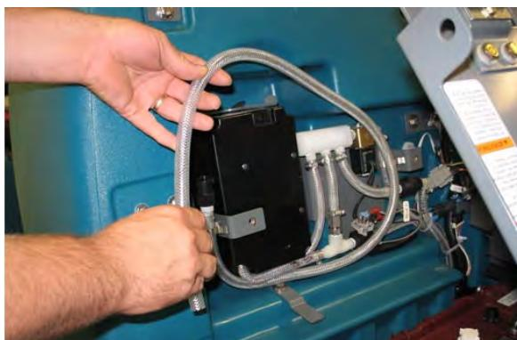
8. 将排气软管从与 ec-H2O 总管连接的洗地头上断开。
