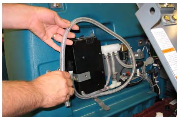
4. 将排气软管从与 ec-H2O 总管连接的洗地头上断开。
