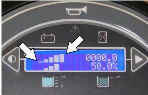
电瓶充满电后，5格全部点亮。当显示屏上没有显示任何格时，重新充电电瓶。
