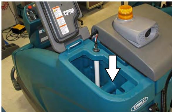
11. 将 ec-H2O 系统排气软管放入一个空容器中。
