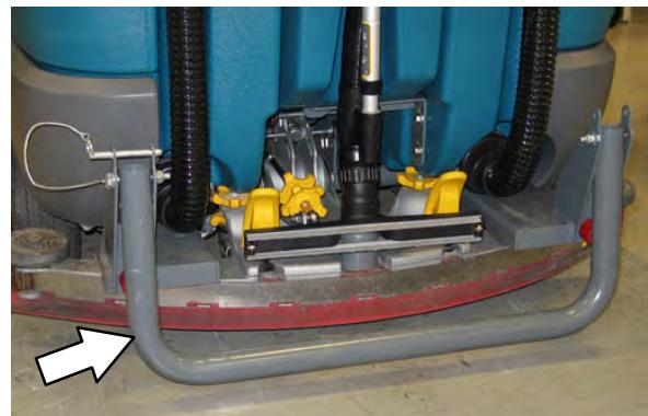
要接合后吸水扒罩，拉出插销，降低罩杆，然后重新插入插销。
