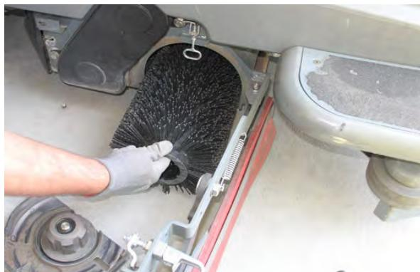
5. 放置刷子，双排端朝向洗地头开口。在驱动轮轴上引导新刷子。
