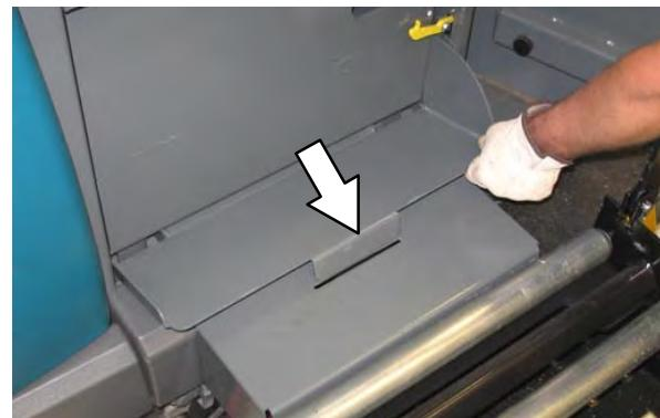
6. 踩压地板锁左侧，设置电瓶车地板锁。
