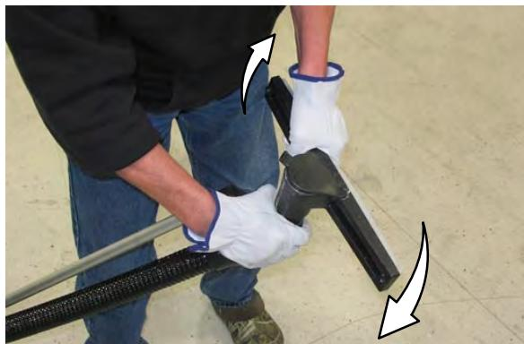
5. 按压真空风扇/吸水扒按钮打开真空风扇。吸水扒将彻底降低。
