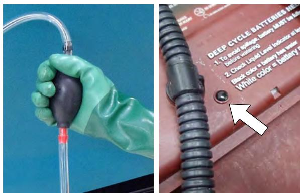
7. 加水完毕后，将防尘罩装回到电瓶注水管上，并将手泵软管存放在机器电瓶舱内以供将来使用。
