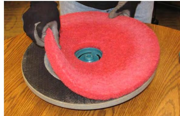
4. 翻转或更换洗地垫。将洗地垫放在针座中央，重新安装中央盘以将百洁垫固定在针座上。
