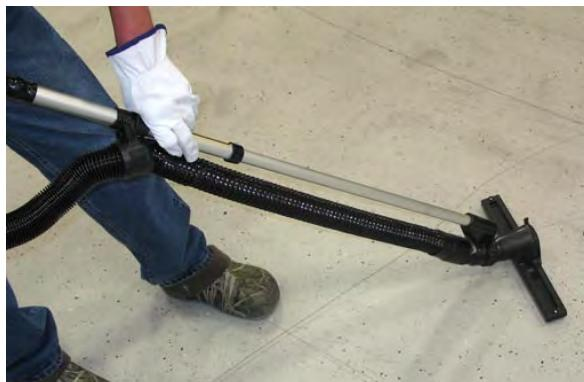
7. 真空使用结束后，按下 真空风扇/吸水扒按钮关闭真空风扇。吸水扒将升高。
