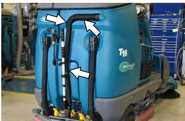
12. 将真空吸扒系绳扣入清水箱，以将真空吸扒/吸水扒真空软管固定在机器上。
