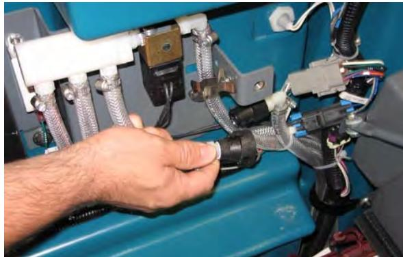
5. 将排水管连接到上一步中与排气软管断开的 ec-H2O 总管。
