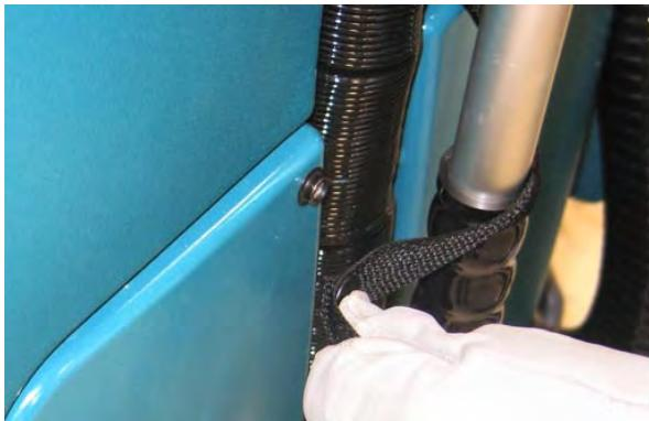
2. 从后吸水扒上取下真空吸扒/吸水扒真空软管。
