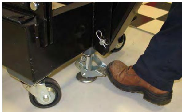
7. Εάν χρειαστεί, ρυθμίστε το ύψος των ράουλων του αμαξίδιου μπαταριών. Τα ράουλα του αμαξίδιου μπαταριών πρέπει να είναι στο ίδιο ύψος με τα ράουλα μπαταριών του μηχανήματος. Ρυθμίστε το ύψος και στις δύο πλευρές του αμαξίδιου μπαταριών.
