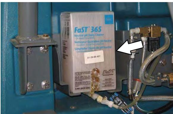
3. Αφαιρέστε το διάτρητο τμήμα από το νέο κουτί του FaST-PAK. ΜHN αφαιρέστε τη σακούλα από το κουτί. Τραβήξτε το σύνδεσμο του εύκαμπτου σωλήνα από το κάτω μέρος της σακούλας και αφαιρέστε τον εύκαμπτο σωλήνα από τον σύνδεσμο.
