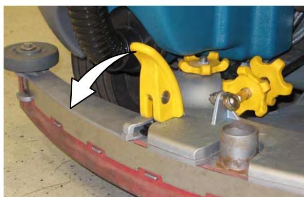
4. Τραβήξτε τη διάταξη του πίσω ελαστικού μάκτρου από το μηχάνημα.
