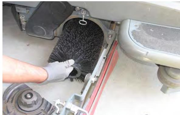
5. Τοποθετήστε τη βούρτσα με το διπλής σειράς άκρο προς το άνοιγμα της κεφαλής καθαρισμού. Οδηγήστε τη νέα βούρτσα επάνω στην πλήμνη κίνησης.
