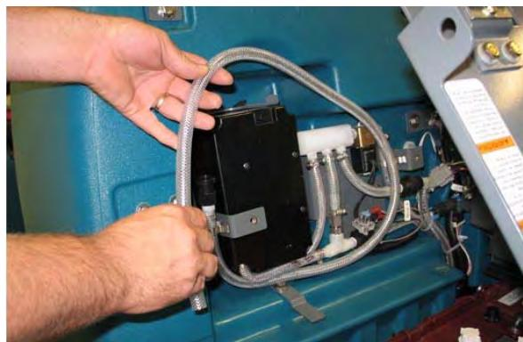
4. Αποσυνδέστε το σωλήνα εξόδου της κεφαλής σκουπίσματος από το σωλήνα πολλαπλής του ec-H2O.
