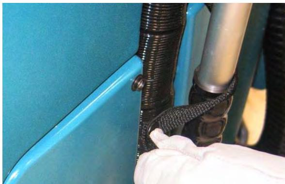
2. Αφαιρέστε το σωλήνα αναρρόφησης / το σωλήνα αναρρόφησης μάκτρου από το πίσω ελαστικό μάκτρο.
