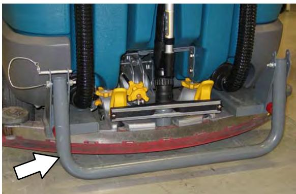
Για εμπλοκή της προστατευτικής διάταξης του πίσω ελαστικού μάκτρου, τραβήξτε τον πείρο, χαμηλώστε τη ράβδο της προστατευτικής διάταξης και επανατοποθετήστε τον πείρο.
