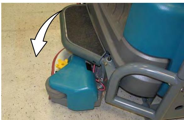
3. Αφαιρέστε τα ρουμπινέτα που συγκρατούν τη διάταξη του ελαστικού μάκτρου πλευρικής βούρτσας στο μηχάνημα και αφαιρέστε τη διάταξη του ελαστικού μάκτρου από το μηχάνημα.
