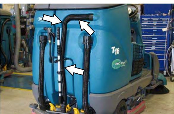
12. Ασφαλίστε το λουράκι του σωλήνα αναρρόφησης στον κάδο διαλύματος καθαρισμού για να ασφαλίσετε το σωλήνα αναρρόφησης/το σωλήνα αναρρόφησης ελαστικού μάκτρου στο μηχάνημα.
