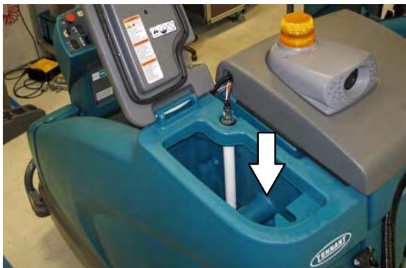
11. Τοποθετήστε το σωλήνα εξόδου του συστήματος ec-H2O σε ένα άδειο δοχείο.
