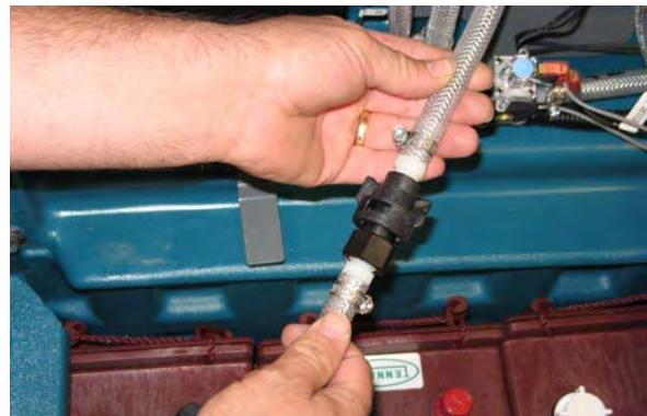
6. Τοποθετήστε το σωλήνα αποχέτευσης σε ένα άδειο δοχείο.
