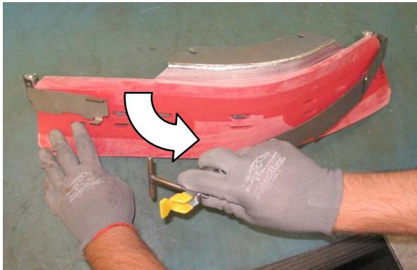
**ΣΗΜΕΙΩΣΗ:** Παρατηρήστε ποιες σχισμές του ελαστικού μάκτρου είχαν τοποθετηθεί επάνω στο πλαίσιο του ελαστικού μάκτρου, προτού αφαιρέσετε το ελαστικό μάκτρο.
