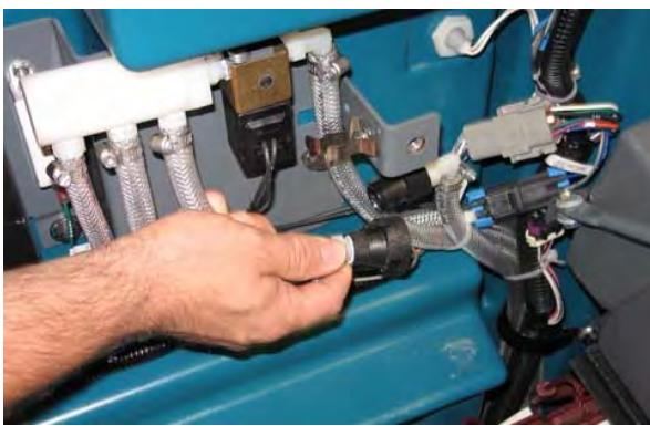
9. Συνδέστε το σωλήνα αποστράγγισης με το σωλήνα πολλαπλής ec-H2O που αποσυνδέθηκε από το σωλήνα εξόδου στο προηγούμενο βήμα.
