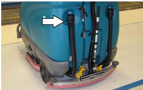
3. Κρατήστε το σωλήνα αποχέτευσης κοντά σε αποχέτευση δαπέδου, στρίψτε το ακροφύσιο αποχέτευσης για να ανοίξει και τοποθετήστε το σωλήνα κοντά στην αποχέτευση δαπέδου.
