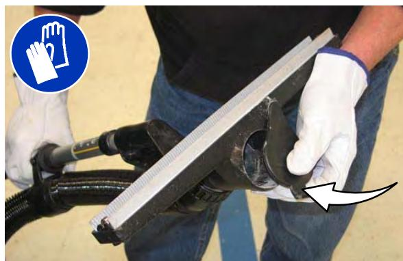
4. Γυρίστε το ακροφύσιο αναρρόφησης στη θέση αναρρόφησης και επεκτείνετε τη λαβή στο μήκος που θέλετε.
