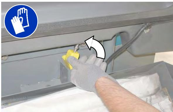
2. Αφαιρέστε τη χοάνη ακαθαρσιών από τη διάταξη προκαταρκτικού σκουπίσματος και αδειάστε τη χοάνη.
