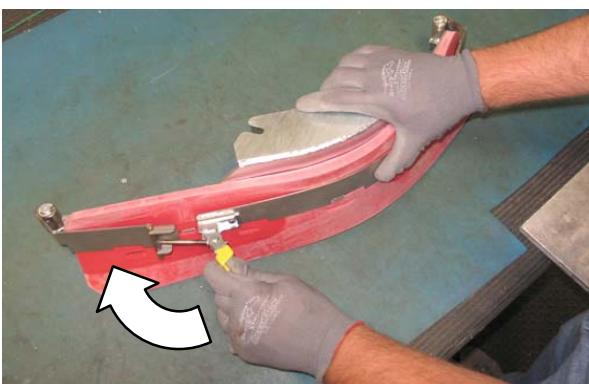
8. Τοποθετήστε ξανά τη διάταξη του ελαστικού μάκτρου της πλευρικής βούρτσας στη διάταξη της πλευρικής βούρτσας.
