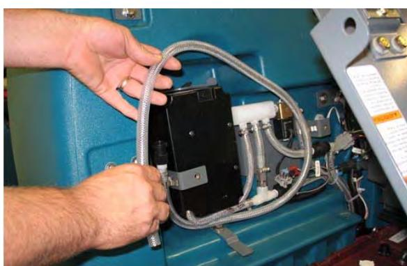
4. Αποσυνδέστε το σωλήνα εξόδου της κεφαλής σκουπίσματος από το σωλήνα πολλαπλής του ec-H2O.
