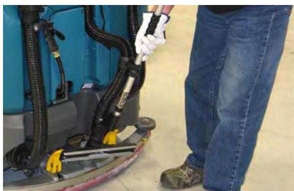
3. Τοποθετήστε το καπάκι του σωλήνα αναρρόφησης στην υποδοχή αναρρόφησης του σωλήνα αναρρόφησης.
