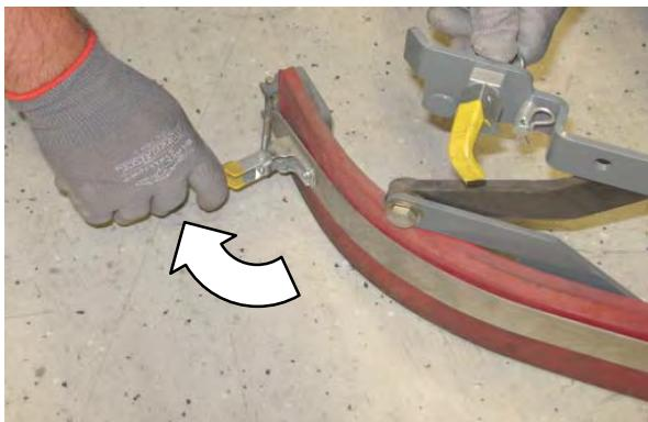
4. Αφαιρέστε τη λάμα συγκράτησης από τη διάταξη του πλευρικού ελαστικού μάκτρου.
