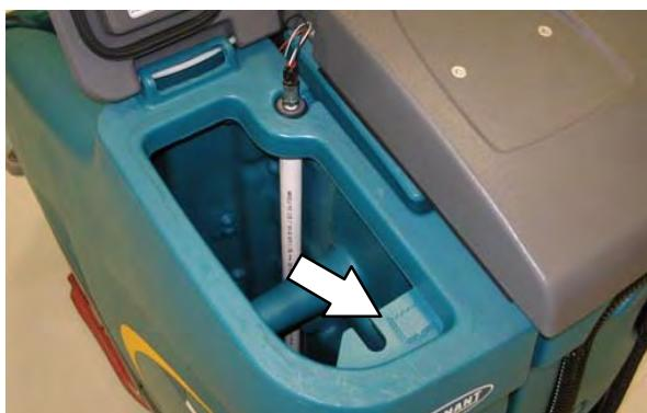
3. Γεμίστε τον κάδο ακαθάρτου υγρού με νερό (που να μην ξεπερνά τους 60°C). Γεμίστε τη δεξαμενή ακαθάρτου υγρού λίγο περισσότερο από το επάνω μέρος του φίλτρου ES.
