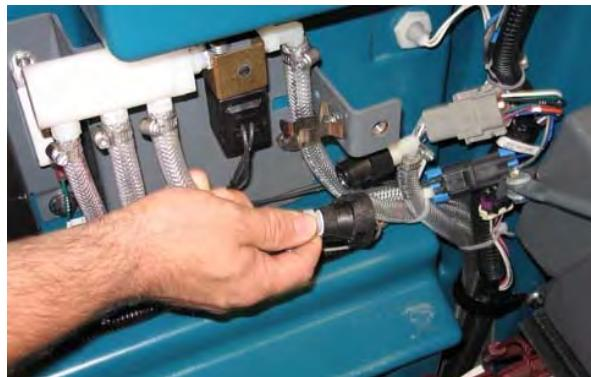
5. Τοποθετήστε το σωλήνα αποχέτευσης σε ένα άδειο δοχείο.
