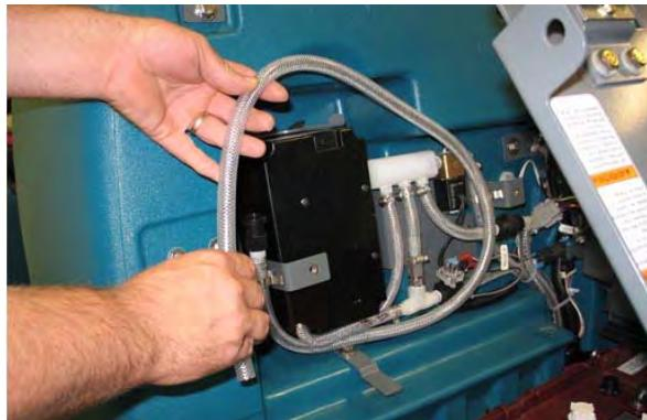
8. Αποσυνδέστε το σωλήνα εξόδου της κεφαλής τριψίματος από το σωλήνα πολλαπλής του ec-H2O.
