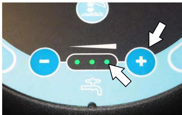
10. Spustením stroje nechajte nemrznúcu zmes RV prejsť celým systémom.
