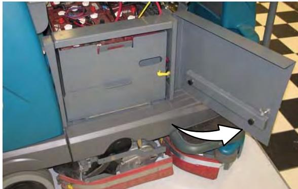
3. Odpojte konektor stroja od batérií.
