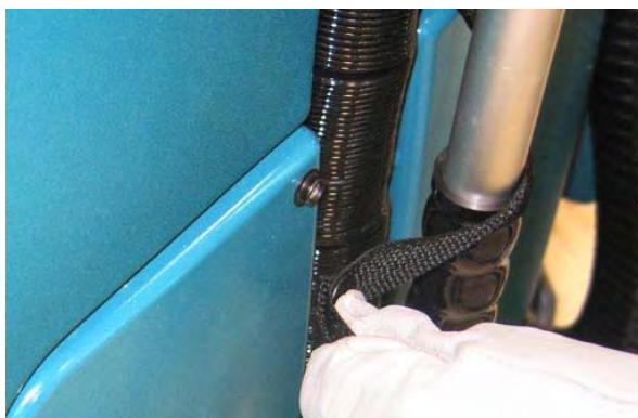
2. Vyberte dýzu vákuovej tyče a hadicu z úložného vaku pri zadnej stierke.
