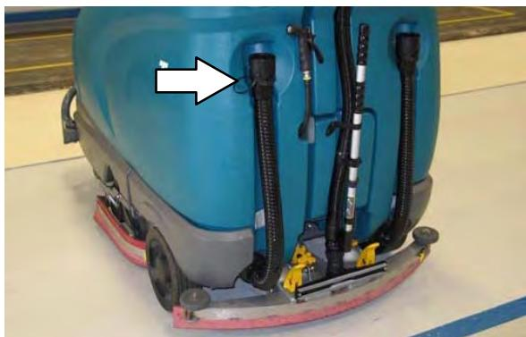
3. Pridržte odpadovú hadicu stroja pri odpadovom odtoku v podlahe, otvorte hadicu potočením trysky a položte ju tak aby z nej mohol vytekať obsah do otvoru v podlahe.
