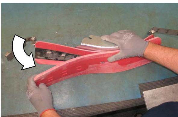
**POZNÁMKA:** Listy stierky majú dve súpravy drážok na nastavenie sklonu listu stierky. Stierky namontujte/znovu namontujte tak, aby bol sklon približne 12 mm (0,50 palca) pre hladké podlahy a 15 mm (0,62 palca) pre drsné podlahy.
