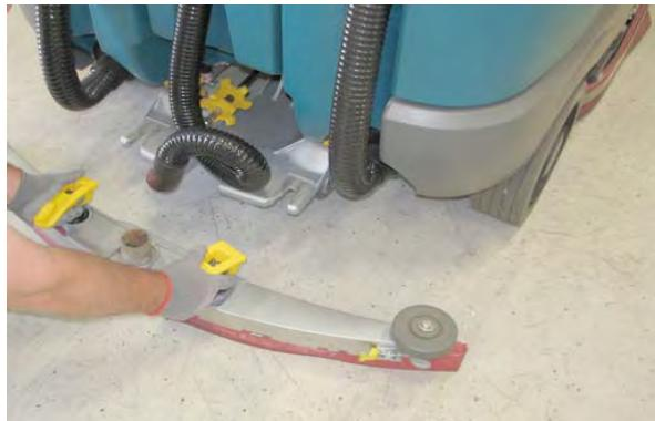
5. Uvoľnite pásovú svorku a odstráňte páska zo súpravy so stierkou (Obrázok ).
