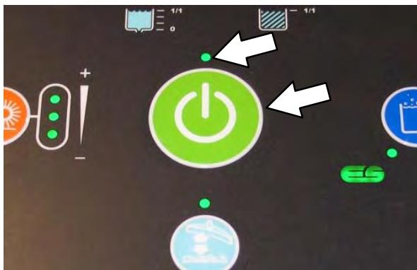
3. Stlačte **tlačidlo čistenia** a nastavte režim (ec-H2O, FaST, or ES)- Indikátor nad spínačom sa rozosveti.
