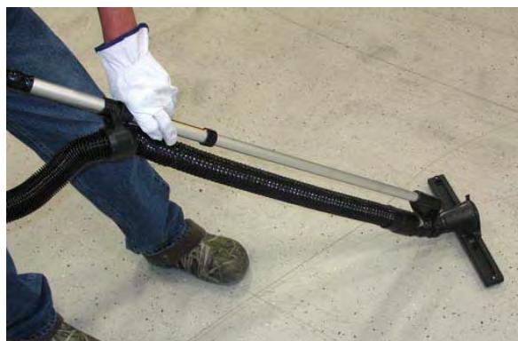
7. Po skončení vysávania stlačte tlačidlo čistiaceho vákuového ventilátora/stierky, aby ste vypli vysávanie. Stierka sa zdvihne.
