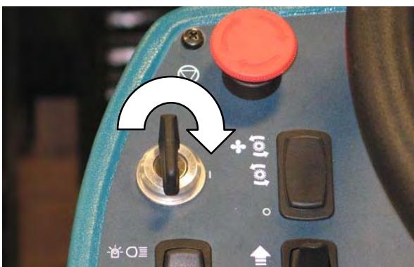
9. Cyklus vyplachovania spustite stlačením a uvoľnením spínača vyplachovania modulu ec-H2O.
