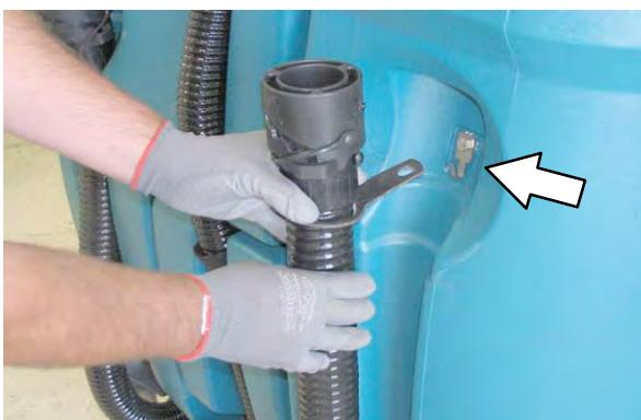
9. Denne kontrolujte vstupný filter vákuového ventilátora. Vyčistite vstupný filter vlhkou handrou alebo hadicou, keď je špinavý. Pred znovu inštaláciou filtra ho nechajte najskôr kompletnie vyschnúť.
