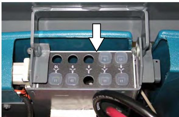
Ističe 11 až 19 sú umiestnené na elektrickom paneli.
