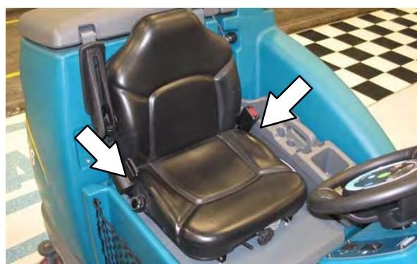
Ovládač nastavenia hmotnosti operátora ovláda pevnosť sedadla. Pomocou mierky vedľa ovládača nastavenia hmotnosti môžete určiť pevnosť sedačky pre operátora.
