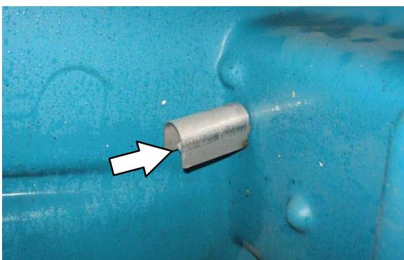
6. Stroje ES: Vypláchnite filter v spodnej časti nádrže na roztok a tlakový spínač vo vrchnej časti nádrže.
