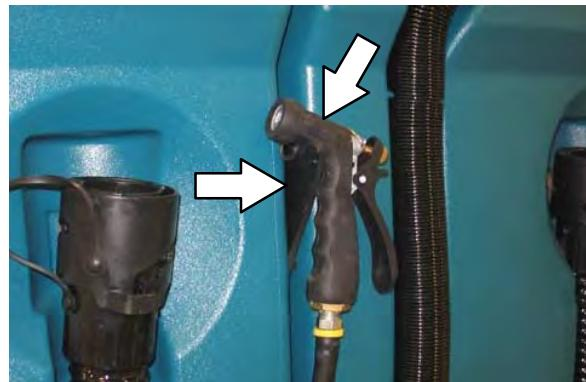
6. Stlačením dolnej časti spínača rozprašovacej dýzy vypnete prívod vody. Svetlo na spínači sa zapne, keď sa rozprašovacia dýza aktivuje.
