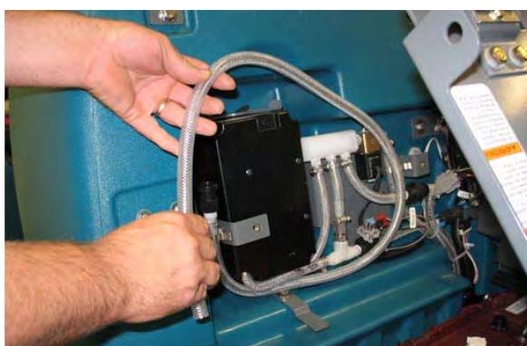
4. Odpojte odtokovú hadicu čistiacej hlavy od ec-H2O potrubia.
