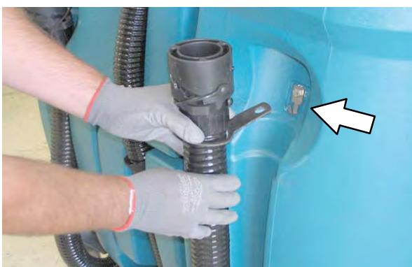
9. Preglejte vhodni filter ventilatorja sesalca vsak dan. Če je vhodni filter umazan, ga očistite z vlažno krpo ali vodo. Pustite, da se filter popolnoma posuši, preden ga namestite nazaj v stroj.
