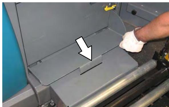
6. Stopite na levo stran talnega zaklepa, da vključite talni zaklep vozička za akumulatorje.
