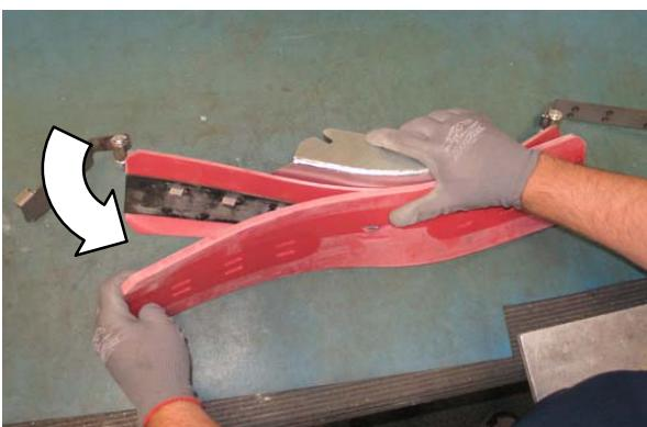
**OPOMBA:** lamele otiralnika imajo dva niza rež za uravnavanje upogiba otiralnika. Namestite/ponovno namestite lamele tako, da je upogib približno 12 mm (0.50 in.) za gladka tla in 15 mm (0.62 in.) za groba tla.
