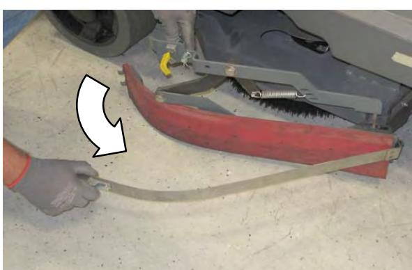
5. Otiralnik odstranite s sklopa stranskega otiralnika.
