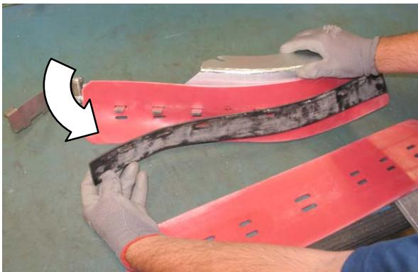
6. Namestite obrnjene/nove lamele otiralnika in držalo na sklop stranske krtače.
