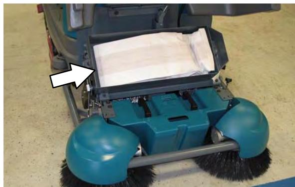
5. Odklenite in spustite pokrov za pred-pometanje.
