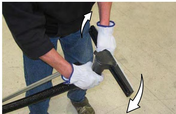
5. Pritisnite gumb ventilatorja sesalca/otiralnika za vklop ventilatorja sesalca. Otiralnik se bo popolnoma spustil.
