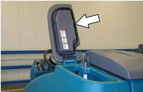
2. Napolnite posodo za raztopino z vodo (ki naj ne presega 60°C / 140°F). Napolnite posodo za raztopino z vodo, dokler ta ni približno 50 mm (2 palca) pod kazalnikom.
