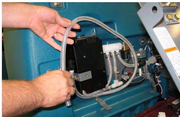
8. Odklopite izhodno cev do čistilne glave iz cevi z razdelilnikom ec-H2O.
