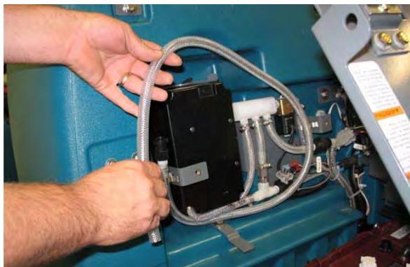
4. Odklopite izhodno cev do čistilne glave iz cevi z razdelilnikom ec-H2O.
