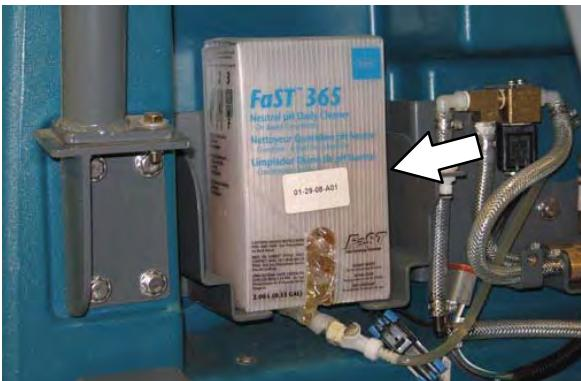
3. Odstranite preluknjan izrezek iz novega kartona FaST-PAK. NE odstranite vreče iz kartona. Potegnite priključek za cev z dna vreče in odstranite pokrov s priključka.
