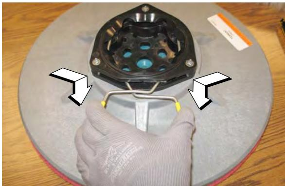
7. Novo krtač potisnite pod čistilno glavo, poravnajte luknjo pogona krtače s pestom pogona krtače in dvignite krtač na pesto pogona krtače, tako da se krtač zaskoči na pesto.
