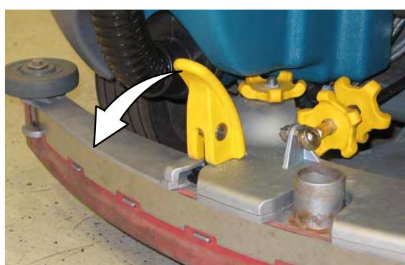
4. Odstranite sklop zadnjega otiralnika iz stroja.
