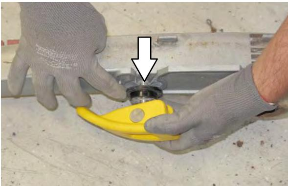
10. Namestite obrnjeno ali novo lamelo otiralnika v zunanje ogrodje. Poskrbite, da je otiralnik pomaknjen do konca navzdol v vsak jeziček na zunanjem ogrodju.
