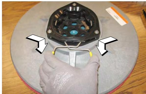
7. Pod sklop stranske krtače postavite novo stransko krtačo in jo dvignite na sklop stranske krtače, dokler se ne zaskoči na sklop.
