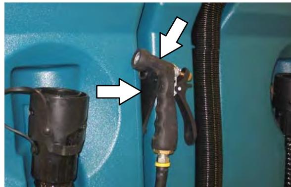
6. Pritisnite spodnji del stikala za pršilno šobo za izklop dotoka vode. Lučka na stikalu se bo vključila, ko je pršilna šoba izključena.
