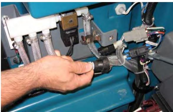
9. Priključite odvodno cev k razdelilniku cevi ec-H2O, ki je bila odklopljena od izhodne cevi v prejšnjem koraku.
