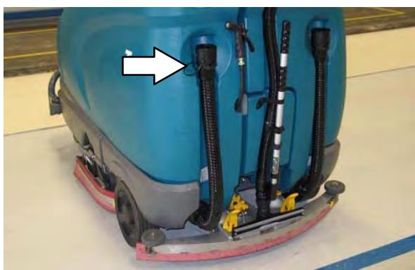
3. Cev za praznjenje držite v bližini talnega odtoka, odprite šobo cevi in cev položite v bližino talnega odtoka.
