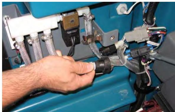
5. Priključite odvodno cev k razdelilniku cevi ec-H2O, ki je bila odklopljena od razdelilnika ec-H2O v prejšnjem koraku.
