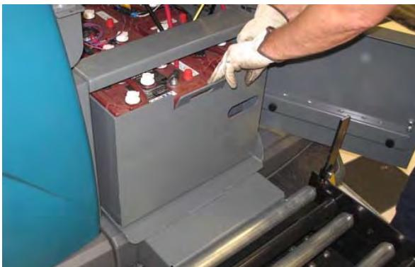
9. Potegnite ročaj, da spustite drog za ustavitev vozička za akumulatorje. To pomaga, da se akumulatorji ne zvalijo z vozička.
