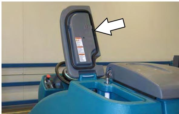
2. Delno napolnite posodo za raztopino z vodo (ki naj ne presega 60°C / 140°F). Vlijte potrebno količino detergenta v posodo za raztopino. Posodo za raztopino še naprej polnite z vodo, dokler ta ni približno 50 mm (2 palca) pod kazalnikom.
