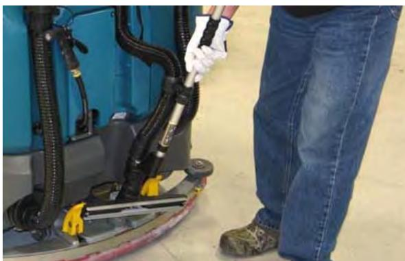
3. Поставете накрайника за вакуумния маркуч в отвора на вакуумния маркуч.
