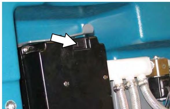
8. Натиснете превключвателя за източване и промиване на модула ес-Н2О, за да изключите системата.
