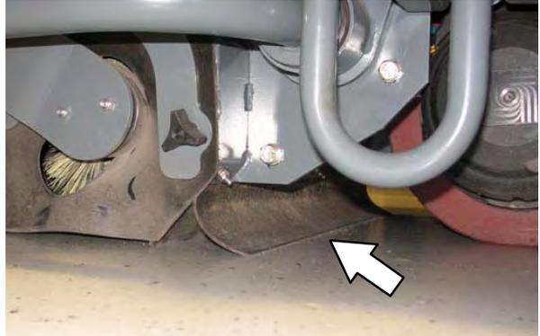
Контролирайте за повреди и износване на всеки 50 часа работа.
