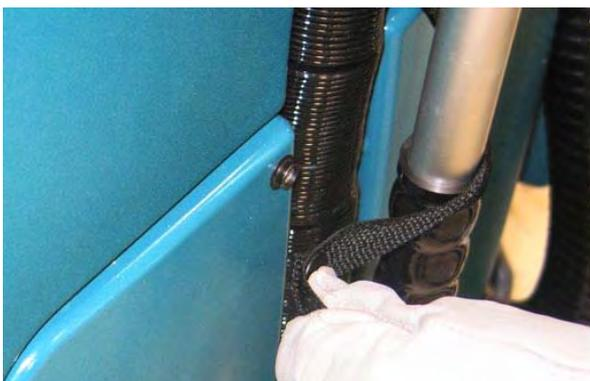
2. Свалете вакуумния (смукателния) маркуч/маркуча на обирача от модула на задния обирач.
