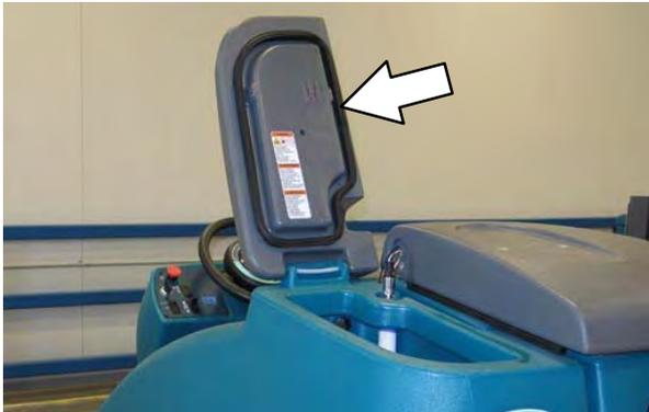
2. Частично заредете резервоара за чист разтвор с вода (температурата не трябва да надвишава 60°C / 140°F). Пълнете резервоара за чист разтвор с вода, докато нивото достигне около 50 мм (2 in) под индикаторната линия.
