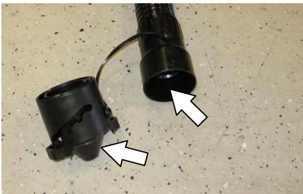
8. Завъртете чашкообразната маншета до затворено положение и окачете маркуча за източване обратно върху резервоара за отработен разтвор/мръсна вода.
