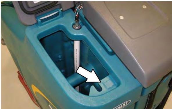
3. Частично заредете резервоара за чист разтвор с вода (температурата не трябва да надвишава 60°C / 140°F). Напълнете резервоара за отработен разтвор точно над горната част на ES филтъра.
