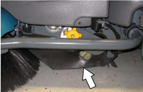
Проверявайте престилките за повреди и износване на всеки 50 часа експлоатация.
