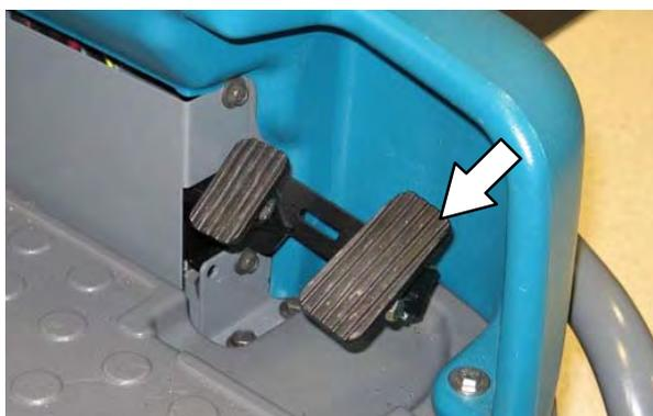
**ЗАБЕЛЕЖКА:** При преместване на *превключвателя за посока* на заден ход ще прозвучи алармен сигнал.
