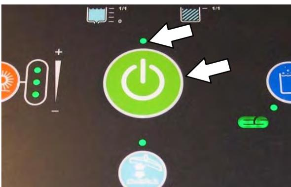
6. Натискайте последователно *бутона Solution increase (+)* (Увеличаване на разтвора) до достигане на най-високото ниво на потока на разтвора.
