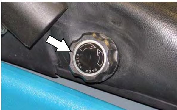
Врътката за регулиране според теглото на оператора регулира твърдостта на седалката на оператора. Използвайте измервателния уред, намиращ се в близост до врътката за настройка според теглото на оператора, за да определите степента на твърдост на седалката за съответния оператор.
