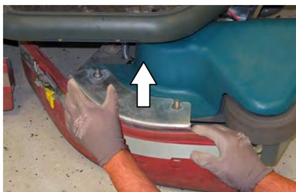
4. Разхлабете фиксатора на бандажа.
