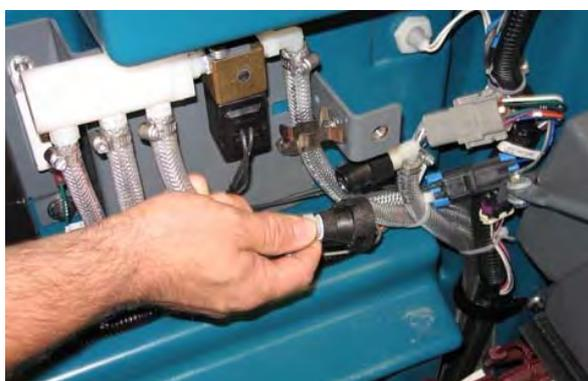
9. Свържете дренажния маркуч към маркуча на колектора на ес-Н2О, който разкачихте от изпускателния маркуч в предходната стъпка.
