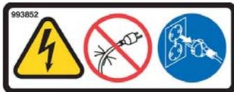
**ΠΡΟΣΟΧΗ:** Κίνδυνος από το ηλεκτρικό ρεύμα. Μην το χρησιμοποιείτε εάν το καλώδιο έχει καταστραφεί. Βγάλτε το καλώδιο από την πρίζα πριν από συντήρηση.
