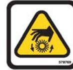
**ΠΡΟΣΟΧΗ:** Περιστρεφόμενη βούρτσα. Μην πλησιάζετε τα χέρια σας. Κλείστε το διακόπτη λειτουργίας του μηχανήματος πριν πραγματοποιήσετε οποιαδήποτε εργασία στο μηχάνημα.
