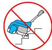
**ΓΙΑ ΤΗΝ ΑΣΦΑΛΕΙΑ ΣΑΣ:** Κατά τη μεταφορά του μηχανήματος, μην χρησιμοποιείτε τους τροχούς του σε σκάλες. Ζητήστε τη βοήθεια άλλου ατόμου ή χρησιμοποιήστε μηχανικό γρύλλο για την ανύψωση του μηχανήματος.
