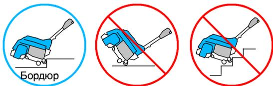
**ДЛЯ БЕЗОПАСНОСТИ:** При транспортировке не катите машину вверх или вниз по лестнице. При подъеме машины обращайтесь за помощью или используйте механический подъемник.
