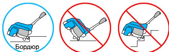
**ДЛЯ БЕЗОПАСНОСТИ: Транспортируя машину, не отклоняйте на задние ролики или колеса и не катите вверх или вниз по лестнице. При подъеме машины обращайтесь за помощью или используйте механический подъемник.**
