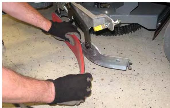
6. Postavite okrenutu ili novu metlicu bočnog brisača na jedinicu bočnog brisača.
