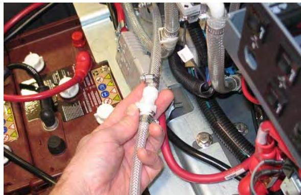
7. Postavite odvodno crijevo sustava *ec-H<sub>2</sub>O* u prazan spremnik.
