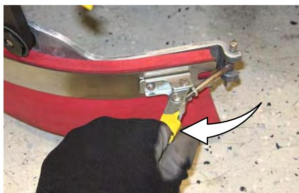
9. Zatvorite potporni poklopac za pristup brisaču kao i poklopac glavne četke.
