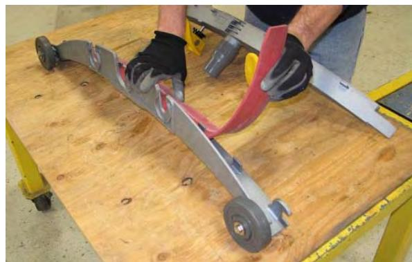
10. Postavite okrenutu ili novu metlicu brisača u vanjski okvir. Provjerite je li brisač u potpunosti pomaknut do ruba ležišta na vanjskom okviru.
