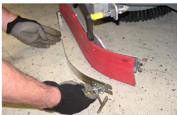
5. Odstranite metlicu brisača s jedinice brisača.
