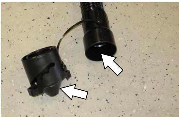
7. Okretanjem zatvorite mlaznicu i postavite odvodno crijevo na predviđenu kuku na spremniku za prikupljanje.
