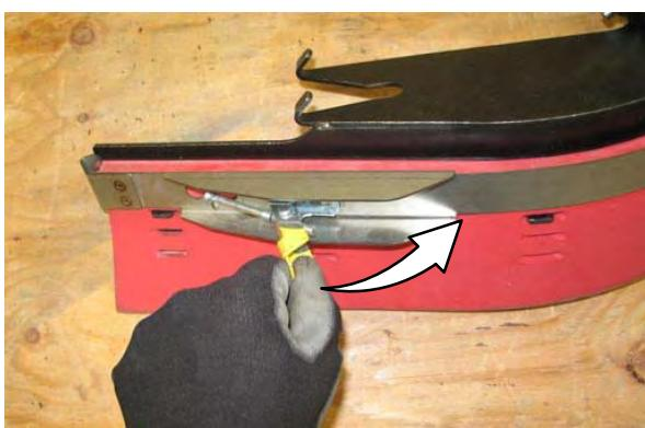
6. Ponovo postavite jedinicu gumenog brisača bočne četke na jedinicu bočne četke.
