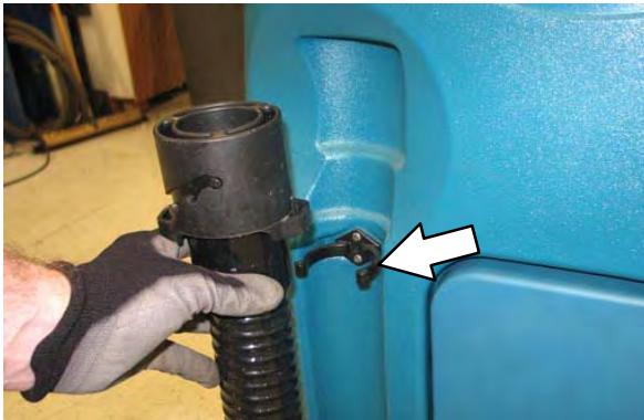
8. Ako filter spremnik rješenje dobiva začepljjen, skinite odvodno crijevo za pristup i očistiti filter.
