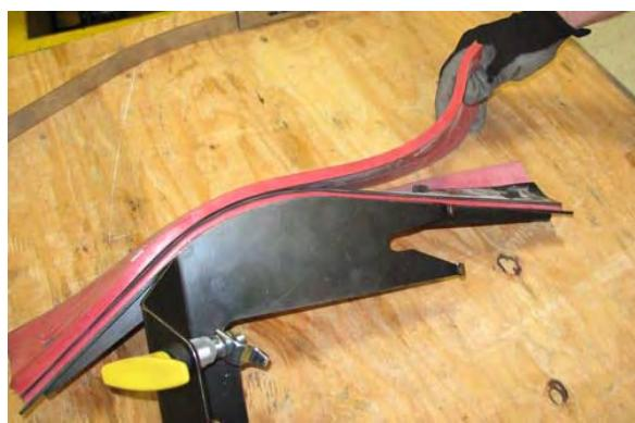
*NAPOMENA: metlice brisača imaju dva para utora za podešavanje savijanja metlica brisača. Postavite gumenе brisače tako da nagib bude približno 12 mm (0.50 in) za glatke površine i 15 mm (0.62 in.) za grube površine.*
