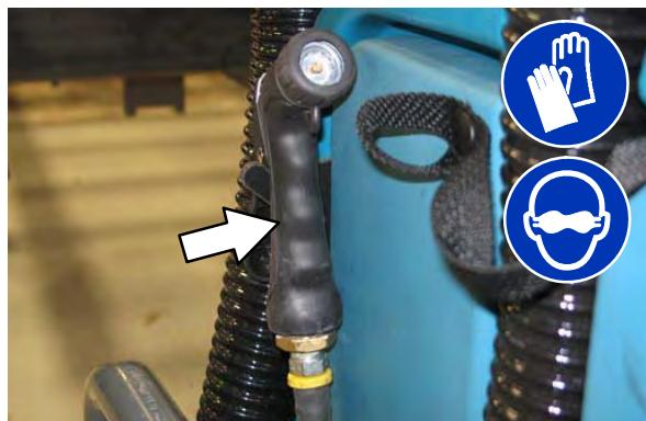
4. Kad završite s čišćenjem, blago povucite crijevo i omogućite da se mlaznica vrati nazad u stroj.
