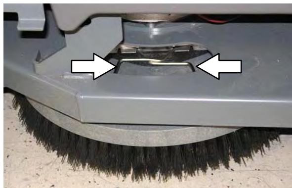
5. Stisnite ručke opruge i pustite da se četka odvoji od stroja. Odvojite četku ispod glave četke.
