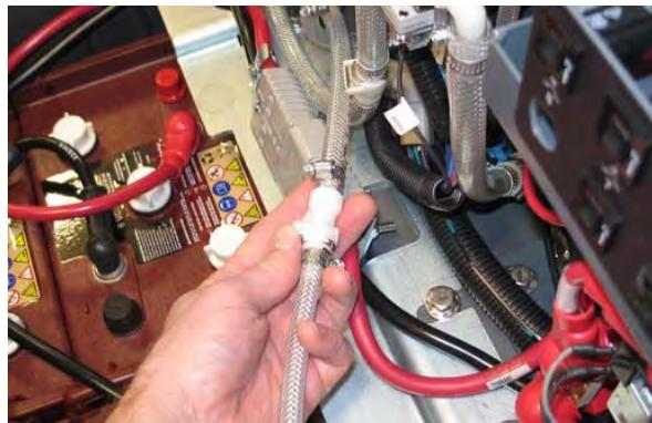
5. Postavite odvodno crijevo u prazan spremnik.
