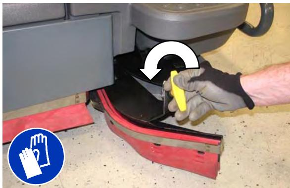
2. Stisnite ručke opruge i pustite da se bočna četka odvoji od stroja.
