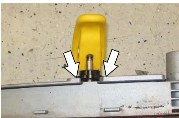
13. Postavite okrenutu ili novu metlicu brisača u unutarnji okvir. Provjerite je li brisač u sigurno pričvršćen na rub ležišta na unutarnjem okviru.
