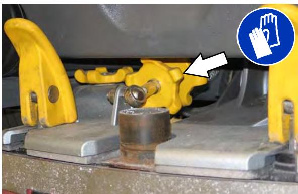
5. Okrećite gumb za podešavanje nagiba u smjeru suprotnom od kazaljke na satu za smanjenje savijanja na krajevima metlica brisača.
