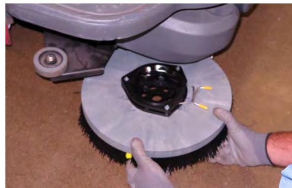
4. Postavite oprugu četke na otvoreno na novoj četki radi lakše montaže.
