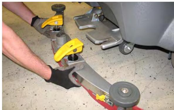
5. Otpustite kvaku držača i uklonite držač sa jedinice brisača.
