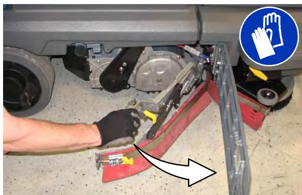
3. Odvojite kvaku držača od jedinice bočnog brisača.
