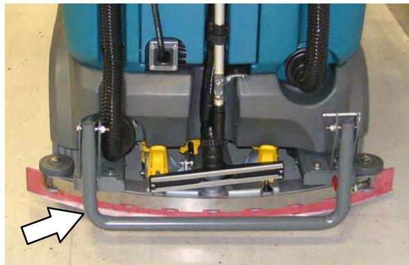
Za uporabu stražnjeg štitnika brisača povucite zatik, spustite štitnik te ponovno vratite zatik.
