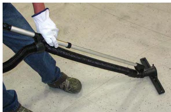
8. Kad završite s usisavanjem, pritisnite *gumb ventilatora/gumenog brisača* za isključivanje ventilatora. Brisač će se podići.
