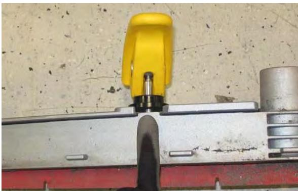
8. Odstranite unutarnji okvir iz vanjskog okvira.
