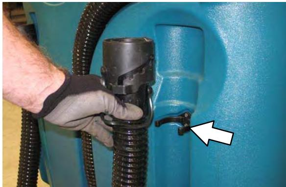
8. Svakodnevno provjeravajte ulazni filter usisavača. Kada se filter zaprlja, očistite ga mokrom krpom ili vodom. Pustite da se filter u potpunosti osuši prije vraćanja filtra na stroj.
