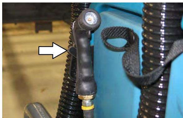
6. Pritisnite donji dio prekidača mlaznice za isključivanje napajanja vodom. Lampica na prekidaču će se isključiti kada se mlaznica isključi.
