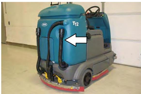
3. Odvodno crijevo držite blizu podnog odvoda, okrenite mlaznicu crijeva kako biste ju otvorili te postavite crijevo u blizini podnoga odvoda.
