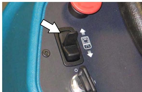
**NAPOMENA:** Kada se smjerni prekidač postavi u položaj za kretanje unazad, čut će se zvučni signal.
