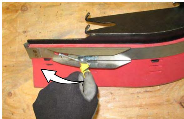
3. Odstranite zaustavni pojас, metlice gumenog brisača i separator od okvira brisača.
