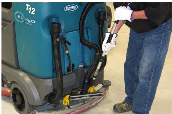
3. Postavite zatvarač crijeva usisavača na priključak na crijevu usisavača.
