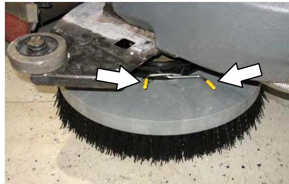
3. Odstranite bočnu četku ispod jedinice bočne četke.
