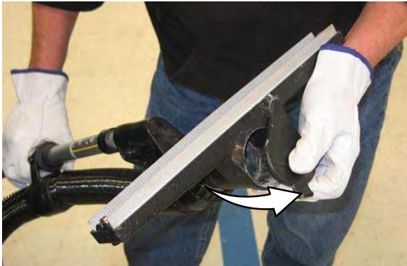
11. Ponovno postavite crijevo usisavača / usisnu cijev gumenog brisača na stražnji dio brisača.
