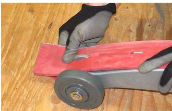
14. Postavite kraj spojnice na kuke držača na unutarnjem okviru.
