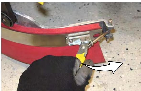
4. Odstranite kvaku od jedinice bočnog brisača.
