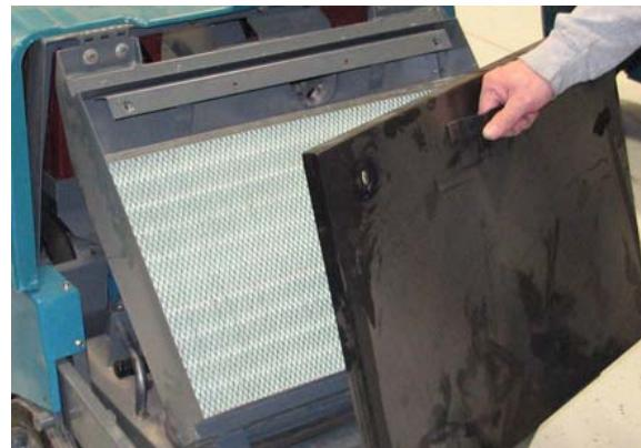
3. Provjerite i očistite ili zamijenite filter za prašinu.
