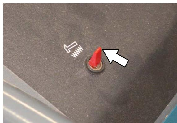
Kada je prekidač postavljen u položaj isključeno, motor vibracijskog uređaja za filter neće raditi kad se stroj isključi. Prekidač treba biti postavljen u položaj isključeno prilikom servisiranja stroja.
