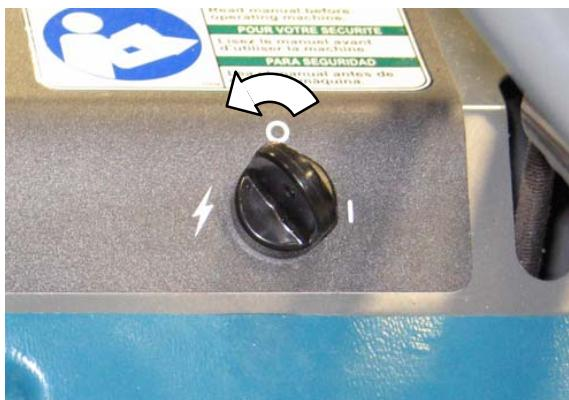
**SAVJET ZA SIGURNOST:** Prije napuštanja ili servisiranja stroja, stroj zaustavite na ravnoj površini, aktivirajte parkirnu kočnicu i isključite stroj.
