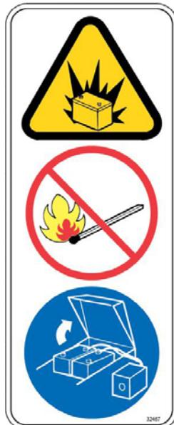
**NALJEPNICA ZA PUNJENE AKUMULATORA - NALAZI SE NA LIJEVOJ BOČNOJ PLOČI.**
