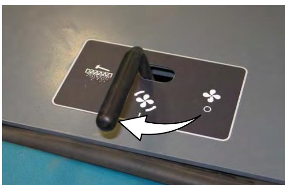
**NAPOMENA:** Kanal ventilatora usisivača treba biti isključen prilikom metenja mokrog otpada.
