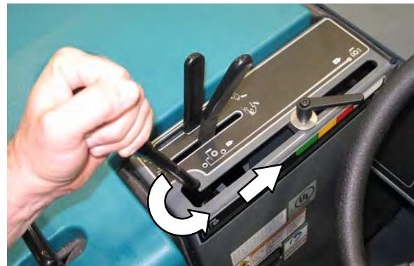
5. Postavite polugu bočne četke u lijevi **bočna četka spuštena i uključena** položaj. Četka će se odmah početi okretati.
