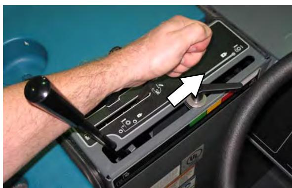
12. Pomjerite ručicu usisivača i vibracijskog uređaja za filter u položaj **ventilator usisivača uključen**.
