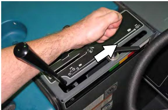
3. Pomjerite ručicu usisivača i vibracijskog uređaja za filter u položaj **ventilator usisivača uključen**.
