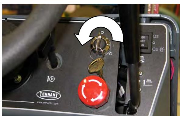
**SAVJET ZA SIGURNOST:** Prije napuštanja ili servisiranja stroja, stroj zaustavite na ravnoj površini, aktivirajte parkirnu kočnicu, isključite stroj i izvadite ključ.
