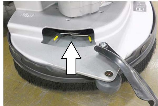
5. Pritisnite opružnu spojnicu palcem i kažiprstom. Četka/pogon jastučića će ispasti iz ležišta pogona.
