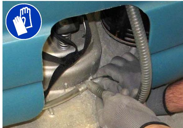
5. Odsvojite žice električne instalacije od svakog motora četke.
