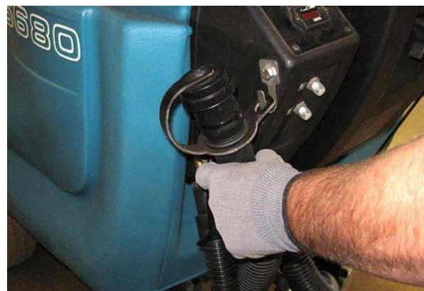
8. Dok držite crijevo uklonite poklopac crijeva za pražnjenje spremnika za prikupljanje te zatim polako spustite crijevo na podni odvod ili sливник.
