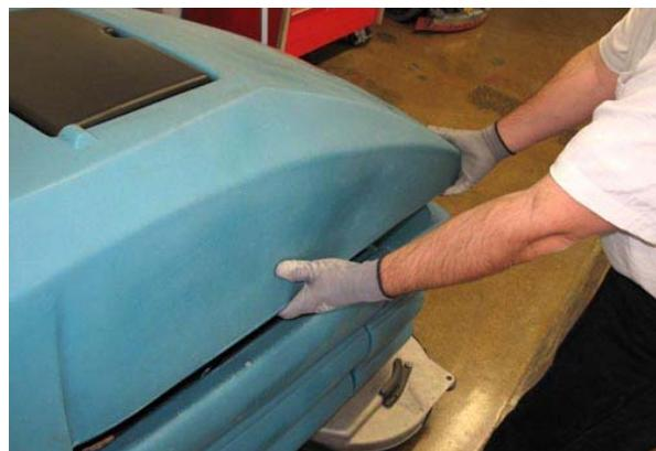
4. Stavite FaST PAK kutiju u držač za kutiju koji se nalazi ispod prednjeg poklopca stroja. Spojite crijevo za dovod na FaST PAK vrećicu.
