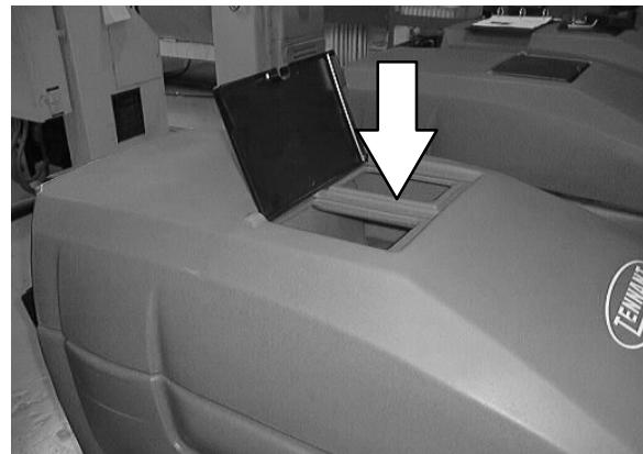
**NAPOMENA:** Prilikom čišćenja opremom FaST ili ec-H2O, KORISTITE ISKLJUČIVO ČISTU I HLADNU VODU. NE DODAJITE agense za čišćenje u spremnik za rastvor. Standardni agensi za čišćenje/obnavljači mogu prouzrokovati kvar na sustavu.
