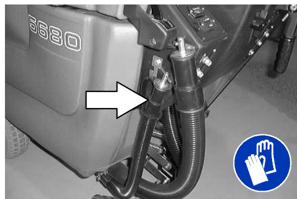
2. Dok držite crijevo uklonite poklopac crijeva za pražnjenje spremnika za rastvor te zatim polako spustite crijevo na podni odvod ili sливник.
