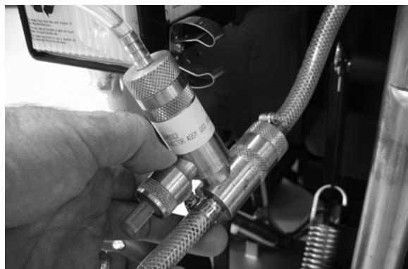
Zamijenite voden i zračni filter. Za montiranje novog zračnog filtra potreban je 8mm inbus ključ.
