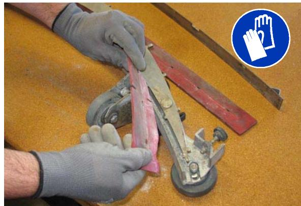
8. Gurnite ploču za pridržavanje naprijed. Zategnite dva vanjska gumba na vrhu sklopa brisača.
