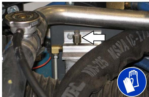
Zatvorite priključak separatora vode / ulja nakon što počne teći neprekidan mlaz goriva.
