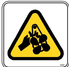
Nalazi se na štitniku remena alternatora, gornjem poklopцу motora, potpori gornjeg poklopca i štitniku remena klima uređaja (ako je stroj opremljen klima uređajem).
