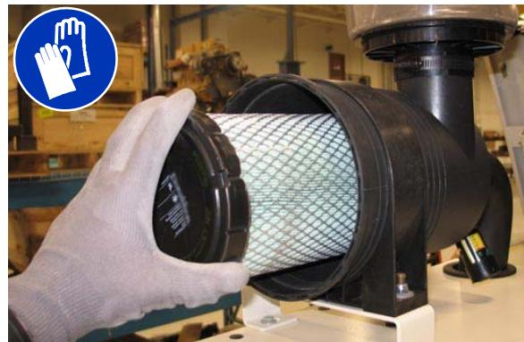
Montirajte filter u kućište zračnog filtra i vratite čep za prašinu tako da ispust za vodu bude okrenut nadolje.
