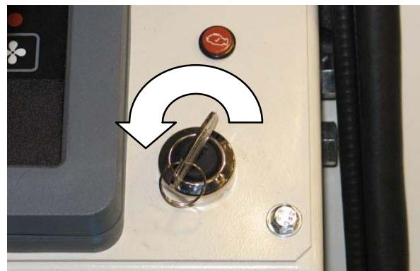
**SAVJET ZA SIGURNOST:** Prije napuštanja ili servisiranja stroja, stroj ne parkirajte u blizini zapaljivih tvari, prašine, plinova i tekućina. Zaustavite stroj na ravnoj površini, aktivirajte parkirnu kočnicu i izvadite ključ
