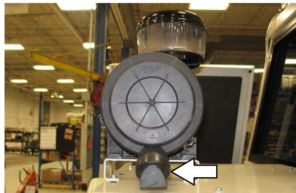
Pritisnite gumb za resetiranje na kraju pokazivača kako biste resetirali pokazivač zračnog filtra nakon što zamijenite filter.
