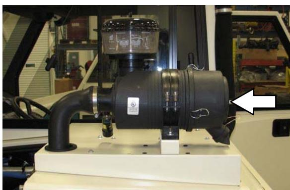
Izvadite filter. Pažljivo očistite čep i unutrašnjost kućišta vlažnom krpom. Očistite površine za brtvljenje kućišta.
