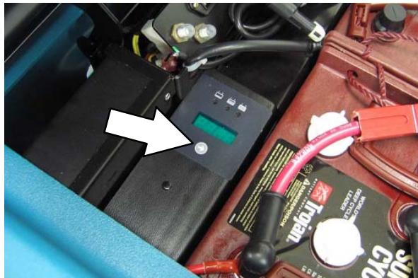
После начала цикла зарядки индикаторные огни будут переходить от красных лампочек к желтым и зеленым. Когда загорится зеленая индикаторная лампочка, цикл зарядки будет завершен. Отсоедините шнур зарядного устройства.
