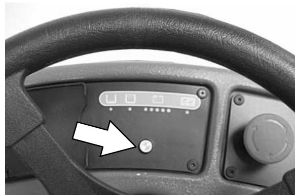
**Модель с ес-H2O-системой:** Если зазвучит аварийный сигнал, и начнет мигать красная индикаторная лампочка ес-H2O-системы, необходимо промыть модуль ес-H2O-системы, чтобы возобновить функционирование ес-H2O-системы (См. ПРОЦЕДУРА ПРОМЫВКИ МОДУЛЯ ес-H2O-СИСТЕМЫ).
