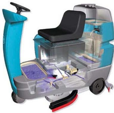
К узлам чистки относятся бак раствора, чистящие щетки или прокладки, швабра, вакуумный вентилятор и бак утилизации.
