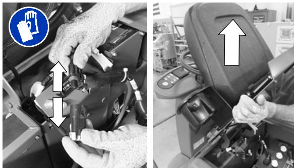
2. Для доступа к картриджу снимите кожух батарейного отсека.
