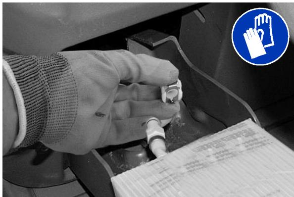
5. Удалите с новой картонной упаковки FaST-PAK перфорированную выбивку. НЕ вынимайте мешок из коробки. Вытяните разъем шланга, расположенный на нижней части мешка, и снимите с разъема колпачок.
