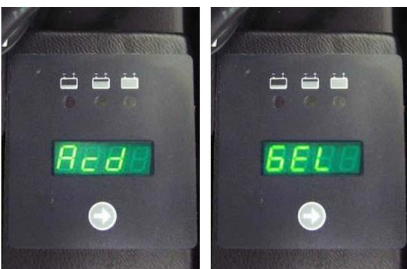
Для изменения установок отключите зарядное устройство от питания, приподнимите уголок ярлыка дисплея и установите переключатели в нужное положение. При изменении установок шнур зарядного устройства должен быть отсоединен.
