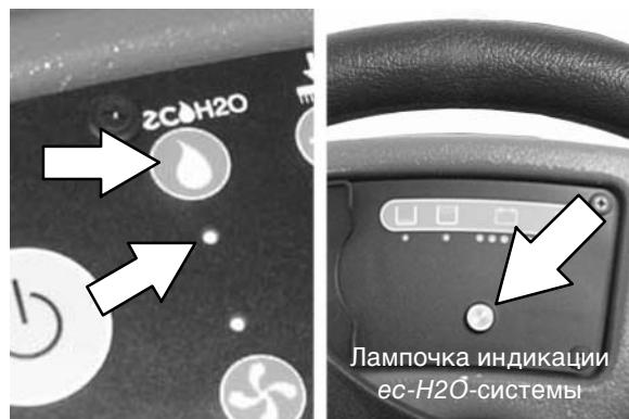
**ВНИМАНИЕ:** на моделях ес-H2O NanoClean при первом включении и после замены картриджа подготовки воды система ес-H2O автоматически изменит заданный поток раствора на период до 75 минут.
