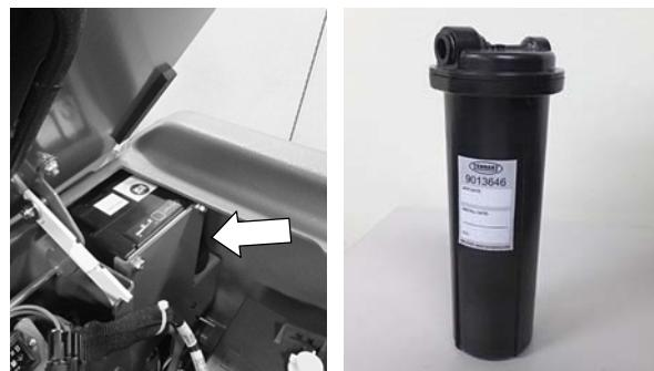
На всех картриджах указана дата их производства. Срок годности неустановленного картриджа составляет один год с даты производства. При установке нового картриджа необходимо сбросить таймер модуля есH2O. См. ЗАМЕНА КАРТРИДЖА ПОДГОТОВКИ ВОДЫ ес-H2O NanoClean.
