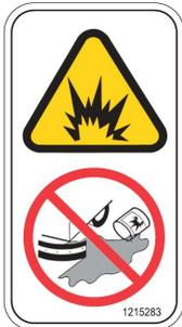
**NALJEPNICA UPOZORENJA - Zapaljivi materijali ili reaktivni materijali mogu izazvati eksploziju ili požar. Nemojte podizati stroj.**
