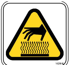
Поставен отстрани на буферната греда, на табелката за отработени газове и на хидравличния резервоар.
