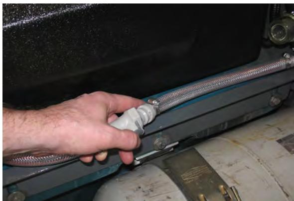
4. Разкачете отточния маркуч на системата ес-H2O от главата на четката и свържете отточния маркуч за промиване (черен конектор) към отточния маркуч на системата ес-H2O.
