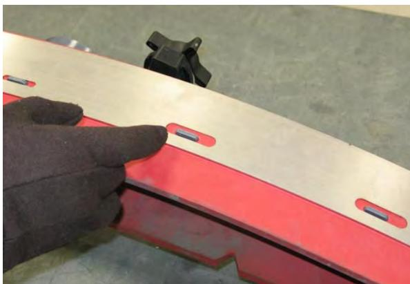
10. Затегнете фиксатора за обтягане на задния застопоряващ пръстен.
