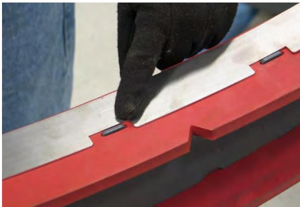
15. Затегнете фиксатора за обтягане на предния застопоряващ пръстен.
