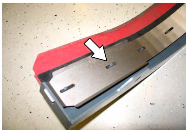
6. Монтирайте отново фиксатора за обтягане на предния застопоряващ пръстен.
