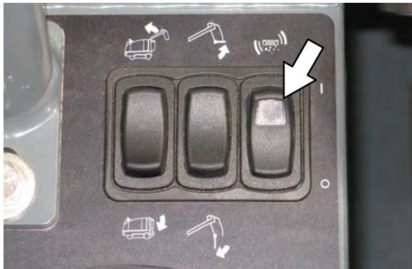
3. След като изтръсването на филтъра приключи, натиснете и задръжте горния край на бутона за повдигане/сваляне на хопера, за да повдигнете хопера. Пуснете бутона когато хоперът достигне желаната позиция.
