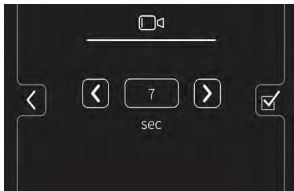
Натиснете бутона за увеличаване, за да увеличите времето за през което трябва да остане включена задната камера когато операторът натисне бутона за изглед на задна камера.
