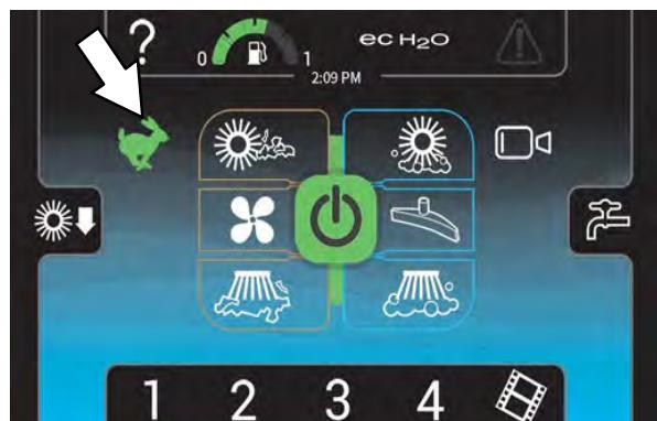
Бутона за скорост на двигателя угасва, когато двигателят е на настройка ниска скорост.
