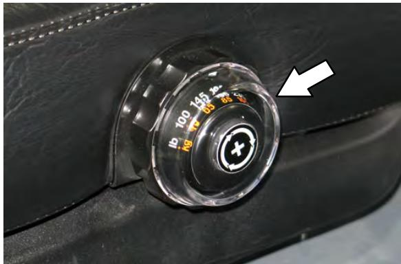
Увеличаване на твърдостта: Завъртете регулировъчния върток за теглото на оператора по посока на часовниковата стрелка.
