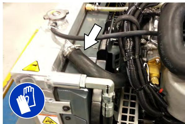
Проверявайте външната част на ядрото/сърцевината на радиатора и охлаждащите ребра за замърсявания на всеки 100 часа работа. Отстранявайте праха чрез продухване или промиване през решетката и ребрата на радиатора в посока, обратна на нормалния въздушен поток. Внимавайте да не накланяте охлаждащите ребра при почистване. Почиствайте щателно, за да предотвратите натрупване на прах по ребрата. За да избегнете спукване на радиатора, оставете радиатора и охлаждащите ребра да изстинат преди почистване.
