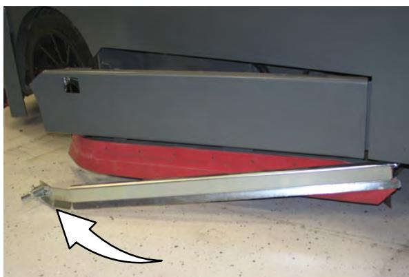
8. Закачете фиксатора към застопорявания пръстен на страничната чистачка.
