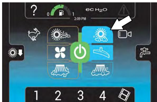
**ЗАБЕЛЕЖКА:** Двата режима за изстъргване и за почистване не могат да работят по едно и също време. Режимът за изстъргване ще прекъсне, а режимът за измитане ще стартира, ако бъде натиснат бутона за почистване докато машината е в режим за изстъргване.
