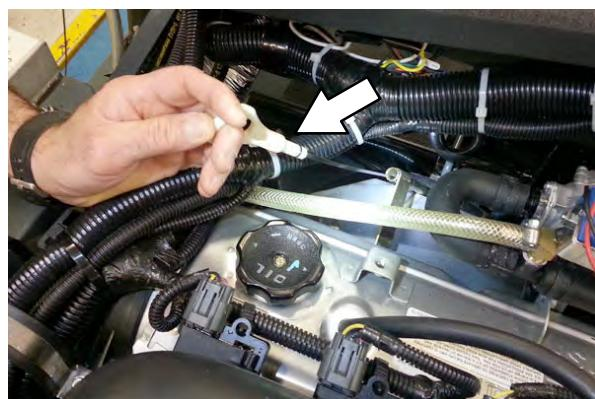
Зареждайте двигателя с масло, докато то достигне ограничителната маркировка на указателя на нивото. **НЕ** наливайте след достигане на последната ограничителна линия на указателя за ниво.
