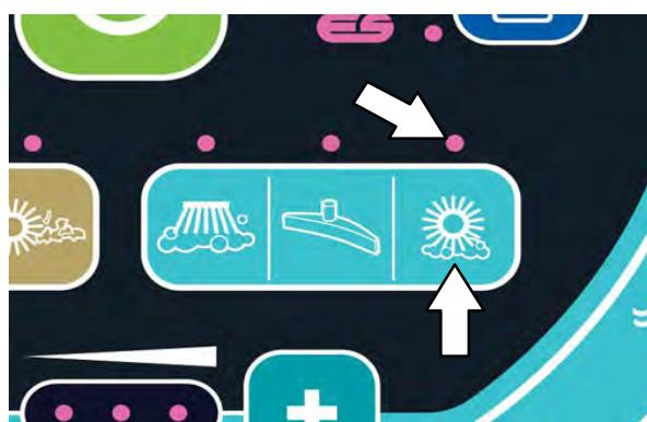
**ЗАБЕЛЕЖКА:** ЗАБЕЛЕЖКА: Двата режима за изстъргване и за почистване не могат да работят по едно и също време. Режимът за изстъргване ще прекъсне, а режимът за измитане ще стартира, ако бъде натиснат бутона за почистване докато машината е в режим за изстъргване.
