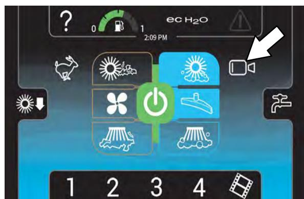
Камерата се включва автоматично когато долната страна на превключвателят за посоки бъде натиснат, за да пусне машината на обратен ход и остава включен през цялото време докато машината работи на заден ход.
