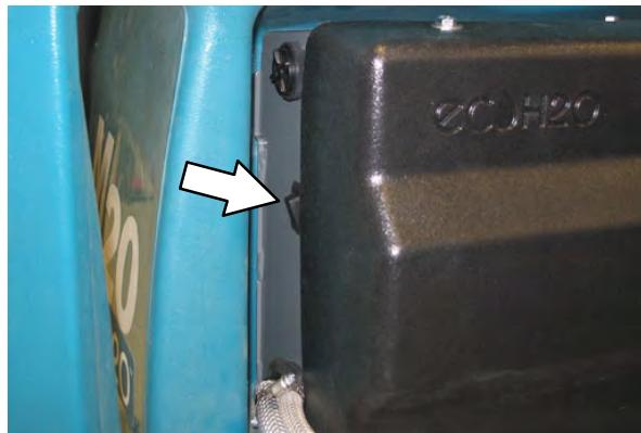
7. Натиснете превключвателя за източване и промиване на модула ес-H2O, за да изключите системата.
