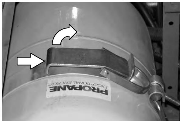
7. Напаснете отвора в борда на резервоара с центровация щифт и внимателно поставете пълният LPG резервоар върху рамката. Закрепете резервоара със стягащата лента.
