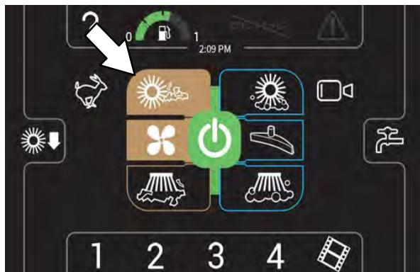
**ЗАБЕЛЕЖКА:** Двата режима за измитане и за почистване не могат да работят по едно и също време. Режимът за измитане ще прекъсне, а режимът за почистване ще стартира, ако бъде натиснат бутона за почистване докато машината е в режим за измитане.
