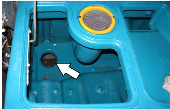
7. Očistite odprtino za praznjenje in znova namestite čep za praznjenje. Potisnite ročico dol, da ga pričvrstite. Preden ga pričvrstite, mora biti čep za odtok dobro vstavljen.
