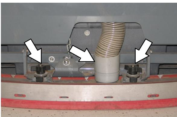
3. Iz sklopa zadnjega otiralnika odstranite oba namestitvena gumba.
