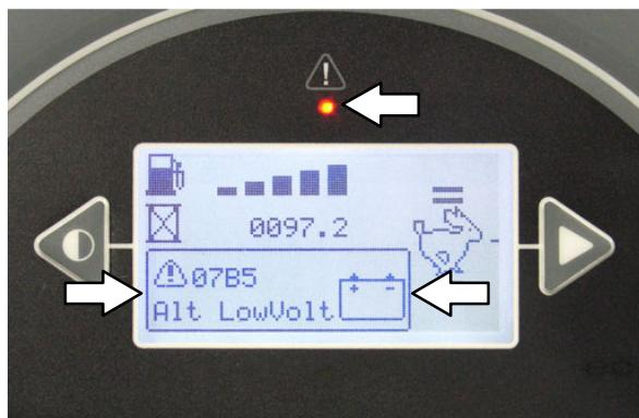
LCD bo prikazal kodo napake/alarmnega stanja. Če je prišlo do več kot ene napake, se bodo kode napak prikazovale izmenično.
