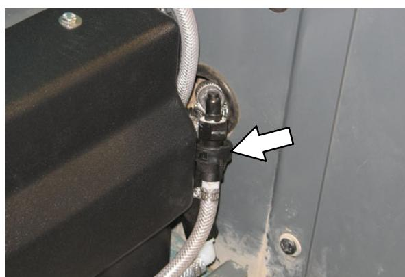
9. Pihajte zrak pod pritiskom (manj kot 344 kPa (50 psi)) v izhodno cev sistema ec-H<sub>2</sub>O.
