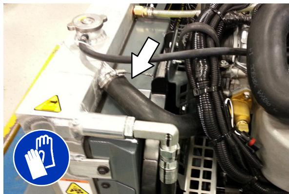
Preglejte zunanjost jedra hladilnika in rebra hidravličnega hladilca za smeti vsakih 100 ur dela. Izpihajte ali sperite ves prah skozi mrežo in rebra hladilnika v nasprotno smer običajnega toka zraka. Bodite previdni, da ne upognite hladilnih reber, ko čistite. Temeljito očistite, da se prah ne sprime na rebrih. Zato da hladilnik ne poči, počakajte, da se hladilnik in rebra hladilca ohladilo, preden začnete s čiščenjem.
