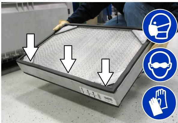
ZRAK-Vedno nosite zaščito za oči, ko uporabljate stisnjen zrak. Pihajte zrak skozi filter za prah v nasprotni smeri puščic. Nikoli ne uporabite več kot 690 kPa (100 psi) pritiska zraka in nikoli bliže kot 50 mm od filtra. To lahko storite tudi, ko je filter za prah v stroju.
