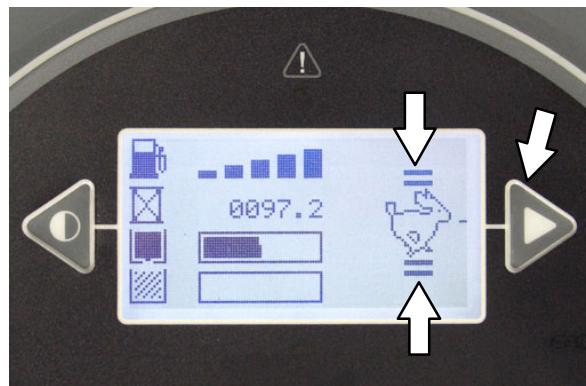
Kadar sta nad ikono za hitrost motorja in pod njem prikazani dve debelejši črtici, tanjši črtici in ikona pa so polni kot ploskev, je motor nastavljen na veliko hitrost.
