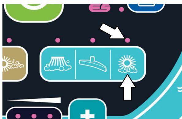
**OPOMBA:** OPOMBA: Stroj ne more hkrati pometati in čistiti. Če za način delovanja izberete čiščenje, potem pa pritisnete koli gumb za pometanje, se preneha izvajati funkcija čiščenja in stroj začne izvajati funkcijo pometanja.
