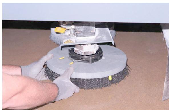
5. Postavite vzmet krtače na novi krtači v odprt položaj, da olajšate namestitev.
