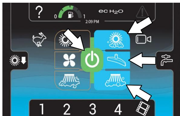
Robovi vseh izbranih gumbov za čiščenje in pometanje bodo osvetljeni, kar označuje, da so v načinu mirovanja, dokler ne pritisnete gumb **1-STEP**. Izbrani gumbi bodo postali v celoti osvetljeni, ko boste pritisnili **gumb 1-STEP**.
