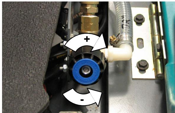
**OPOMBA:** Tlak nastavite najprej na izvlekljivem podaljšku in šele potem na sistemu.
