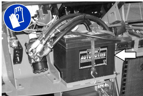
**ZA VARNOST:** Med vzdrževanjem stroja preprečite stik s kislino v akumulatorju.
