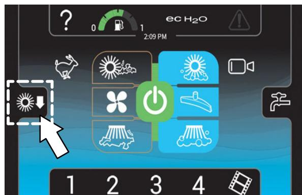
Uporabite gumb za povečanje pritiska krtač (+) in gumb za zmanjšanje pritiska krtač (-) za spremenjanje nastavitev pritiska krtač. Kazalnik pritiska krtač kaže trenutno nastavitev pritiska krtač.
