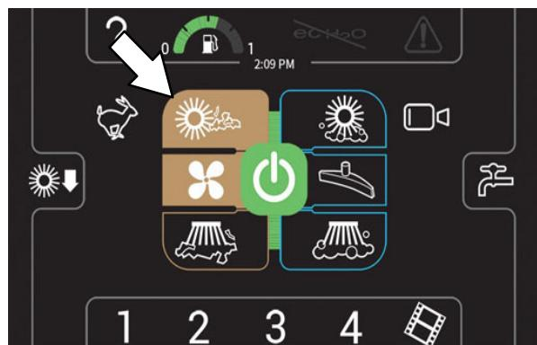
**OPOMBA:** Stroj ne more hkrati pometati in čistiti. Če za način delovanja izberete pometanje, potem pa pritisnete koli koli gumb za čiščenje, se preneha izvajati funkcija pometanja in stroj začne izvajati funkcijo čiščenja.
