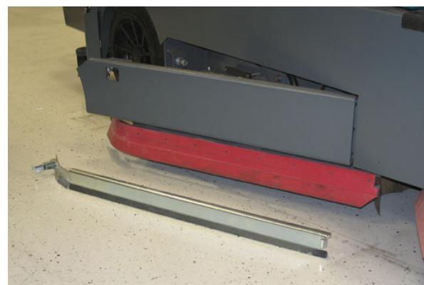
5. Odstranite lamelo stranskega otiralnika. Če zunanjji rob lamele otiralnika ni obrabljen, obrnite lamelo otiralnika z lamelem z druge strani stroja. Odvrzite lameло, če sta oba robova obrabljeni.
