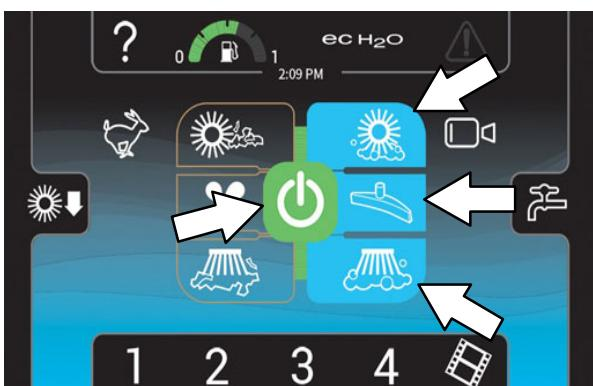
**OPOMBA:** Sistema FaST ali ec-H2O NIKOLI ne smete vklopiti med običajnim čiščenjem. Običajne čistilne snovi lahko povzročijo okvaro sistema FaST ali ec-H2O. Pred začetkom dela s sistemom FaST ali ec-H2O tank za raztopino izpraznите, splaknite in znova napolnite s hladno čisto vodo.
