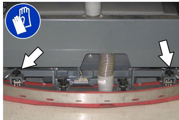
4. Po spremembah zapeljite stroj naprej, ter znova preverite upogibanje lamel.
