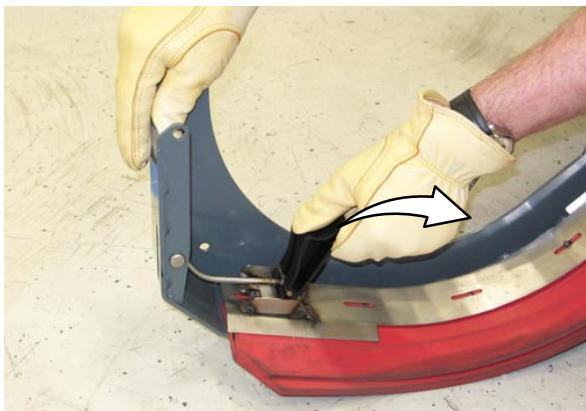
4. Odstranite otiralnike, distančnik in zadrževalnik iz blatnika otiralnika.
