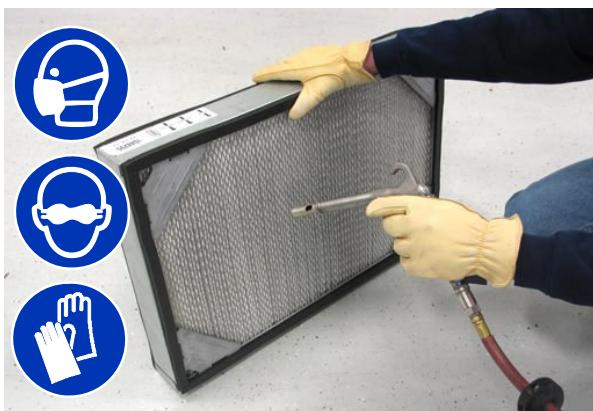
**VODA** - Sperite filter za prah v nasprotni smeri puščic s cevjo z vodo pod nizkim pritiskom.
