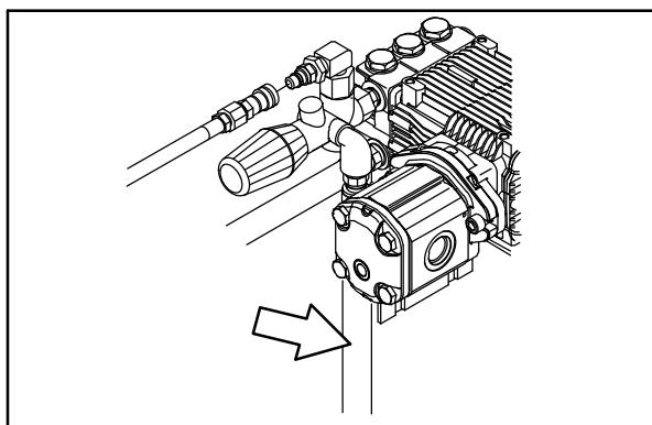
Zaženite tlačni čistilnik za nekaj sekund, da izpraznите sredstvo proti zmrzovanju iz črpalk. Prožilec za nekaj sekund spustite, tako da sredstvo proti zmrzovanju odteče iz povratnega voda v vedro. Izključite stikalo za tlačni čistilnik, zmanjšajte hitrost motorja in povratni vod ponovno priključite na posodo za raztopino.
