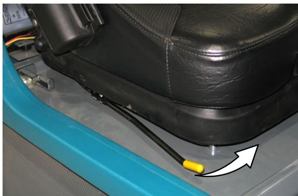
Nastavite: Potisnite ročico navznoter proti sedežu in potisnite sedež v želeni položaj. Spustite ročico, da se sedež zaskoči.
