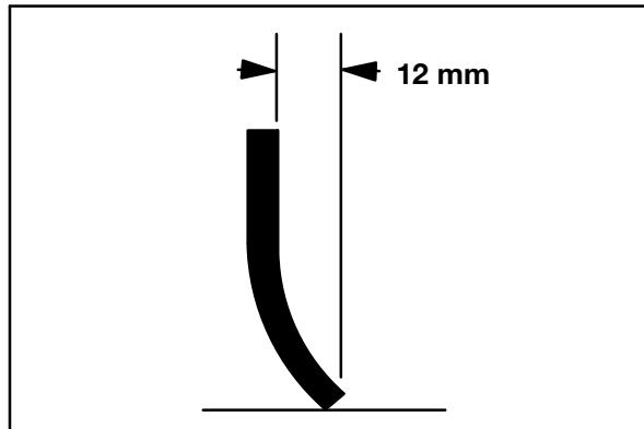
3. Za povečanje upogibanja lamel otiralnika na sploh obrnite nastavljene gume v nasprotni smeri urinega kazalca in za zmanjšanje v smeri urinega kazalca.
