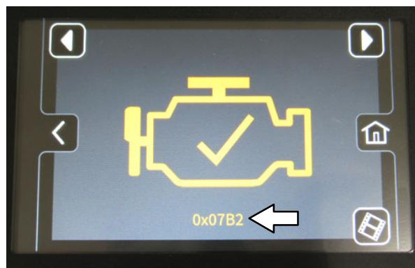
Pritisnite gumb s puščico desno, da se premikate naprej po napakah/alarmnih stanjih.
