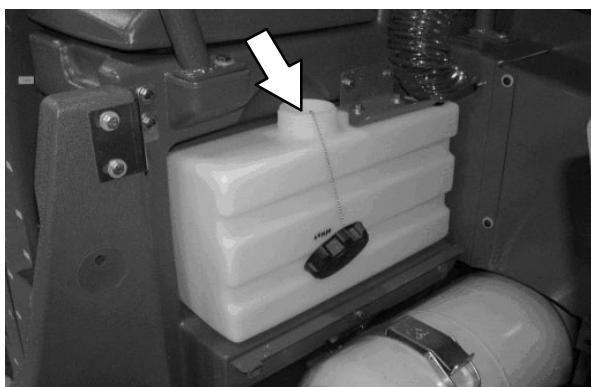
**OPOMBA:** Stroji, opremljeni z izbirnim sistemom PČ/sistemi za merjenje detergenta, morajo napolniti črpalke s tekočino proti zmrzovanju na osnovi propilen glikola oz. za avtodome.
