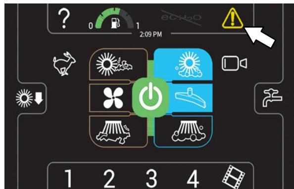
Pritisnite utripajoči rdeči gumb kazalnika za napako, da si ogledate napake. Na zaslonu se bo odprlo okno z napakami/alarmnimi stanji.
