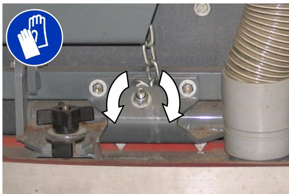
4. Obrnite matico za uravnavanje otiralnika v nasprotni smeri urinega kazalca, da zmanjšate upogib na koncih lamel otiralnika.
