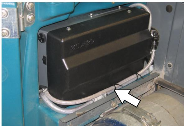
**OPOMBA:** Dovodna in izhodna cev morata biti spodaj med sklopom in ogrodjem ec-H2O, da se ne priščipneta in poškodujeta, ko zaprete pokrov sedeža uporabnika.
