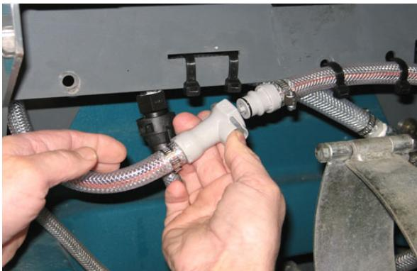
4. Izključite izhodno cev sistema ec-H2O iz cevi do čistilne glave in cev za spiranje izhoda (črna povezava) povežite na ec-H2O izhodno cev.
