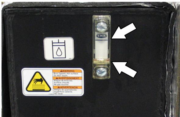
**POZOR!** Ne prenapolnite posode za hidravlično tekočino, ali uporabljajte stroja s premajhno količino hidravlične tekočine v posodi. Saj se lahko poškoduje hidravlični sistem stroja.
