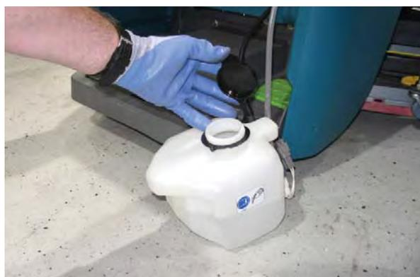
10. Dodatna oprema za automatsko dolijevanje vode u akumulator - U spremnik dolijte destiliranu vodu. Zamijenite čep.
