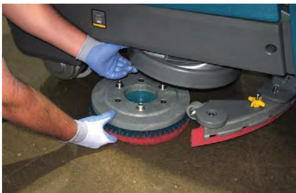
6. **Strojevi opremljeni magnetnim čvorištima za četke:** Gurnite novi pogon četke ili jastučića ispod glave četke i podignite pogon četke ili jastučića dok magnet ne učvrsti četku ili jastučić na čvorište pogona.
