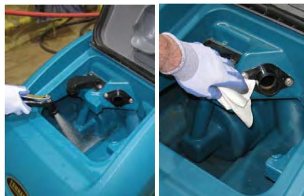
**SIGURNOSNE MJERE:** Prilikom servisiranja stroja ne čistite stroj mlaznicom ili crijevom koje je spojeno na stroj. To može izazvati električni kvar. Koristite vlažnu krpu.
