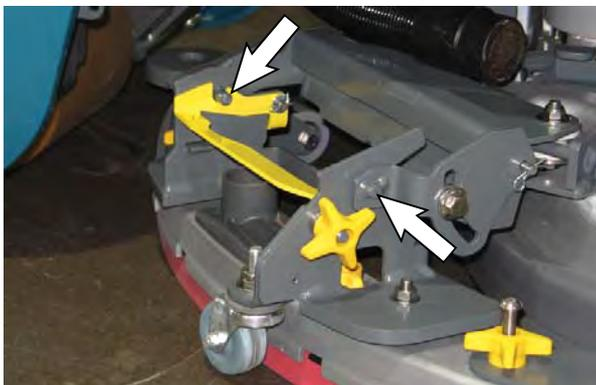
5. Strojevi s glavom četke samo od 20 in. (500 mm): Provjerite da su oba pokretna poklopca četke pozicionirana iznad štitnika glave četke.
