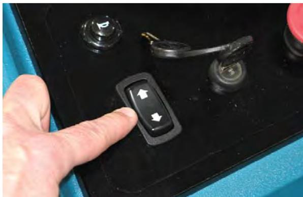
*NAPOMENA: Ako svjetla smjernog prekidača brzo trepere provjerite da vam desno stopalo ne pritišće zelenu papučicu za kretanje. Stroj neće prihvatiti komande smjernog prekidača ako svjetla trepere brzo.*
