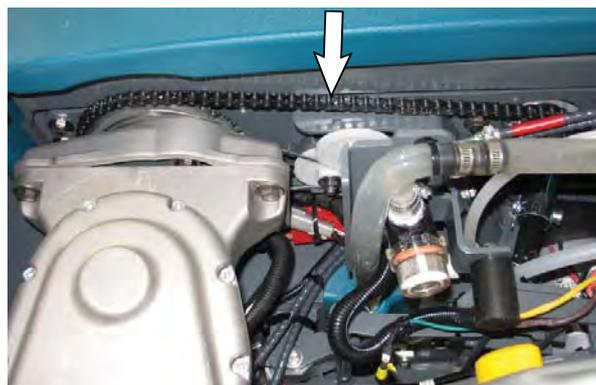
3. Provjerite da kabel upravljača nije oštećen ili istrošen. Koristite mjerač da provjerite da li je kabel upravljača zategnut.
