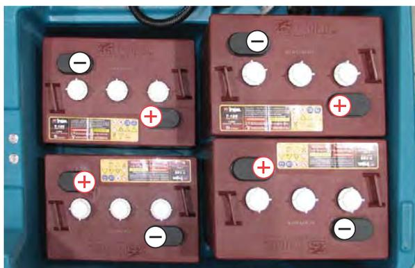
3. Pomoću isporučениh terminalnih spojnika povežite kabele s polovima akumulatora, CRVENA NA POZITIVNI (+) I CRNA NA NEGATIVNI (-). Pritegnite spojeve kabela na akumulatore prema tehničkim podacima proizvođača akumulatora.
