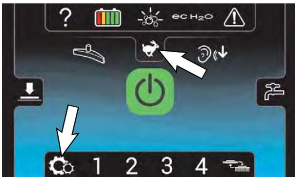
Novi stroj iz tvornice automatski će se pokrenuti u načinu rada nadzornika uz prethodno zadani profil nadzornika. Tvornički dodijeljen kod za prijavu nadzornika na stroj je "1234". Ovaj broj za prijavu nije potreban dok ga ne omogućite. Zadano ime i broj za prijavu na profil nadzornika može se promijeniti na način opisan u ovom odjeljku. Ako zaboravite novi dodijeljeni broj za prijavu u načinu rada nadzornika, koristite kod za oporavak 836626826.
