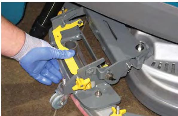
5. Potpuno olabavite dva vanjska gumba na sklopu brisača. Tako će se opružni držač metlice odvojiti od okvira brisača.
