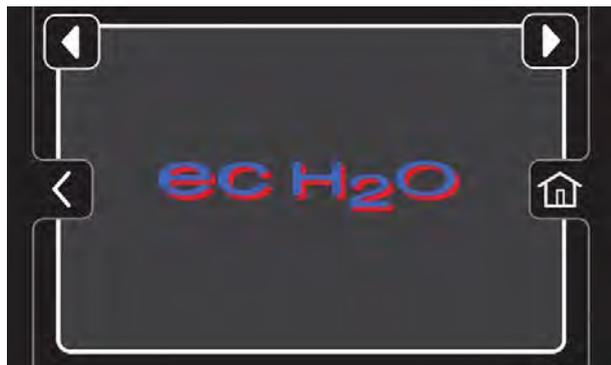
**Žuti zaslon kvara ec-H2O** - Stroj je otkrio kvar ec-H2O sustava ili kvar sustava za vodu.
