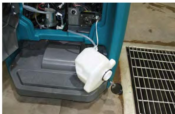
4. Modeli koji nisu opremljeni sa sustavom ec-H<sub>2</sub>O - Uključite stroj i koristite sustav za kontrolu protoka otopine. Isključite stroj kada ugledate antifriz na podu.
