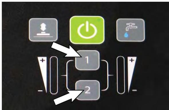
Za podešavanje upravljačkih gumba zone na različite načine ribanja, odaberite željene postavke s donjeg popisa, zatim pritisnite i držite gumb zone sve dok zeleno LED svjetlo ne zatreperi tri puta za spremanje postavke. Za podešavanje zone 3 istovremeno pritisnite gumbe zone 1 i 2.
