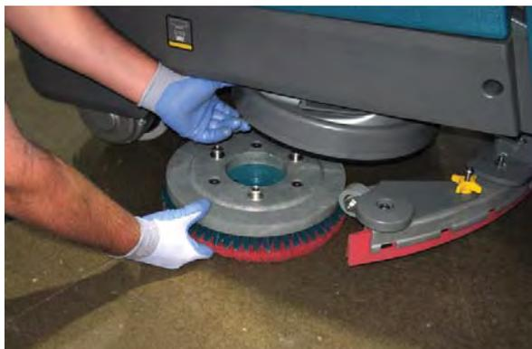
4. **Strojevi opremljeni magnetnim čvorištima za četke:** Gurnite novi pogon četke ili jastučića ispod glave četke i podignite pogon četke ili jastučića dok magnet ne učvrsti četku ili jastučić na čvorište pogona.
