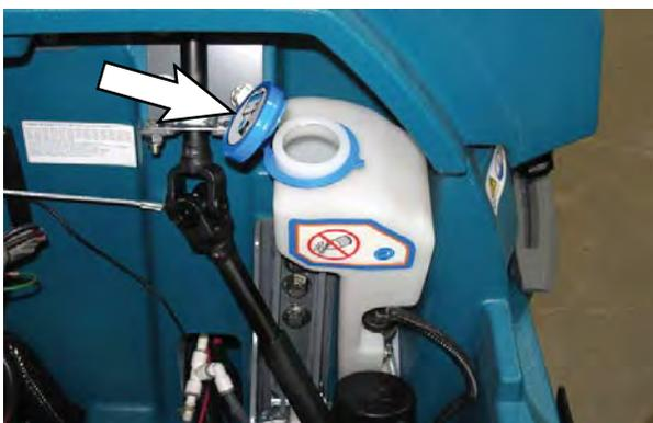
4. U spremnik ulijte destiliranu vodu. Kako biste izbjegli dolazak osjetljivih komponenti u kontakt s vodom, koristite lijevak za automatsko dolijevanje vode u akumulator.
