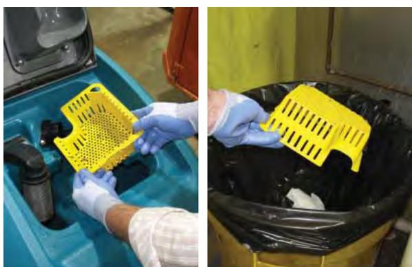
7. Skinite i očistite filter ventila za zatvaranje.
