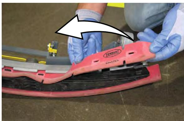
7. Okrenite stražnju metlicu za korištenje novog ruba za brisanje i ponovno montirajte metlice. Pazite da poravnate utore na metlicama s jezičcima na držaču.
