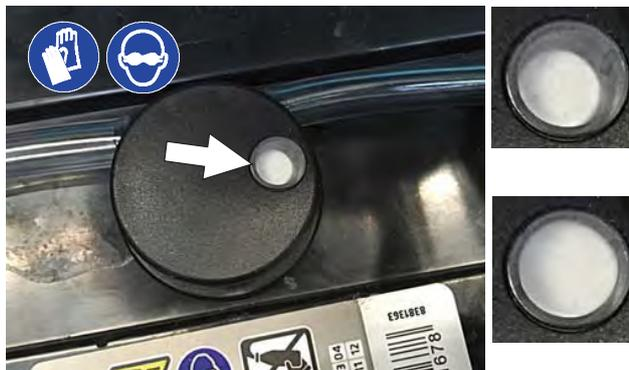
3. Pronađite priključak crijeva za punjenje akumulatora unutar pretinca akumulatora. Povežite ručnu pumpu na sustav za napajanje vodom akumulatora.
