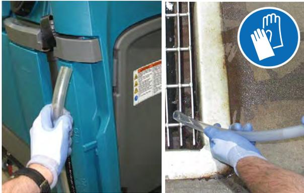
3. Isperite spremnik za otopinu čistom vodom. Čvrsto ponovno pričvrstite crijevo na spremnik za otopinu nakon ispiranja/čišćenja spremnika.
