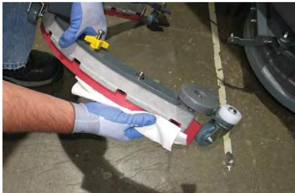
4. Čišćenje štitnika glave četke. Provjerite da nije oštećen ili istrošen. Zamijenite ga ako je oštećen ili istrošen.
