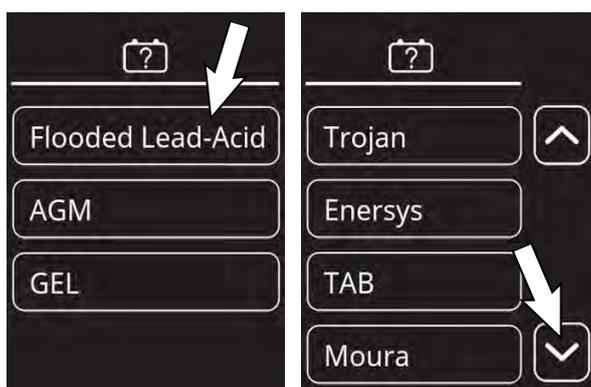
*NAPOMENA: Profil punjača akumulatora i pokazivač ispražnjenosti akumulatora automatski će se reprogramirati kada se odabere tip akumulator.*
