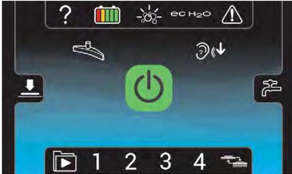
**Način rada nadzornika** - Moguć je rad stroja uz potpuno korištenje svih upravljačkih funkcija, uz konfiguriranje dozvola i ograničenja načina rada nadzornika i mogućnosti prijave. Početni zaslon načina rada nadzornika omogućava pristup gumbima postavki stroja i gumbu maksimalne brzine ribanja.
