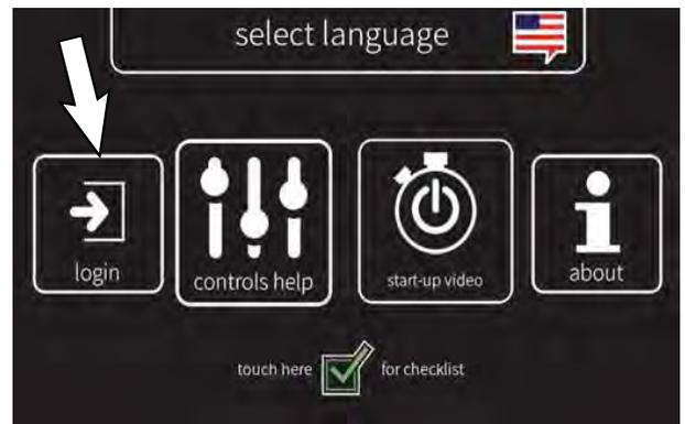
3. Prva uporaba - Unesite tvornički dodijeljen kod za prijavu nadzornika na stroj koji glasi "1234", a zatim pritisnite zeleni gumb "Enter".
