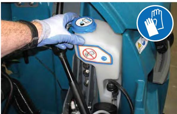
3. Uklonite plavi poklopac sa spremnika za automatsko dolijevanje vode u akumulator.
