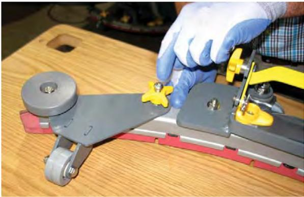
9. Pozicionirajte držač sklopa brisača pored nosača brisača i poravnajte čiode nosača brisača u držaču sklopa brisača.
