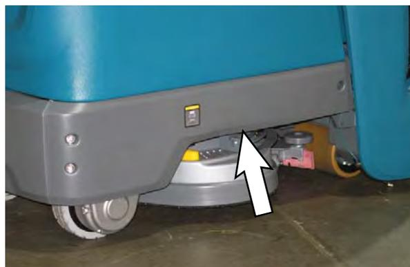
4. Pozicionirajte podnu dizalicu ispod držača/dizalice i poredajte sva crijeva/kabele tako da ne budu pritisnuti kada se stroj podigne s poda.
