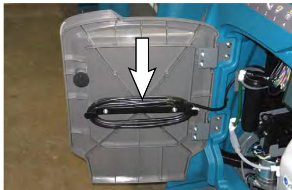
Kod modela opremljenih vanjskim punjačima prvo spojite kabel punjača istosmjerne struje u utičnicu baterije na stroju, zatim uključite strujni kabel izmjenične struje u ispravno uzemljenu zidnu utičnicu. Upute za uporabu pogledajte u korisničkom priručniku vanjskog punjača akumulatora. Nemojte zatvarati spremnik za prikupljanje na kabelima punjača dok se puni s vanjskim punjačem.
