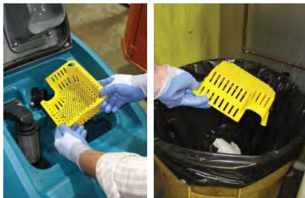
Isperite spremnik za prikupljanje čistom vodom te obrišite sve ostatke nečistoće.
