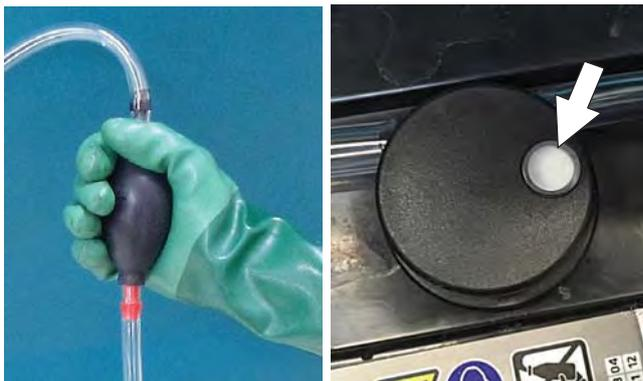
6. Nakon dolijevanja vode vratite poklopac protiv prašine na crijevo za punjenje akumulatora i spremite crijevo ručne pumpe unutar pretinca akumulatora stroja za buduće korištenje.
