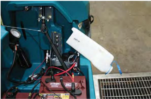
**VAŽNO: NE DOLIJEVAJTE** antifriz u spremnik za automatsko dolijevanje vode u akumulator.
