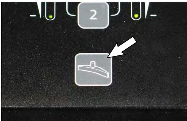
**Strojevi opremljeni Pro-Panel pločom:** Pritisnite gumb 1-Step te zatim pritisnite gumb ventilatora usisivača. Gumb ventilatora usisivača neće više biti osvijetljen a ventilator usisivača će prestati raditi.
