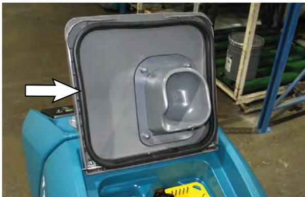
2. Ispraznite spremnik za otopinu. Odstranite filtar spremnika za otopinu i očistite mrežicu. Okrenite posudu za filtar u smjeru suprotnom od kazaljke na satu i izvadite je.
