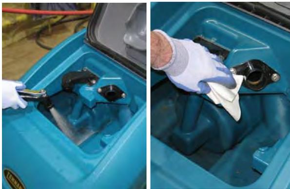
**SIGURNOSNE MJERE:** Prilikom servisiranja stroja ne čistite stroj mlaznicom ili crijevom koje je spojeno na stroj. To može izazvati električni kvar. Koristite vlažnu krp.
