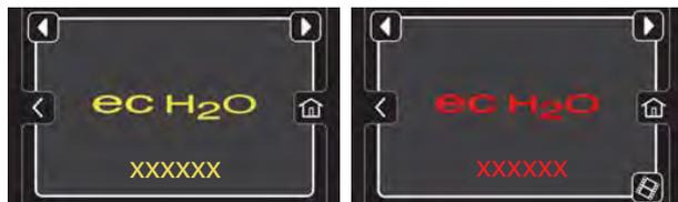
**NAPOMENA:** Ako dođe do kvara na ec-H2O sustavu tada će stroj automatski isključiti ec-H2O sustav i prebaciti na standardno ribanje. Gumb servisnog pokazivača nastavit će treperiti sve dok se ne servisira/popravi kvar ec-H2O sustava.
