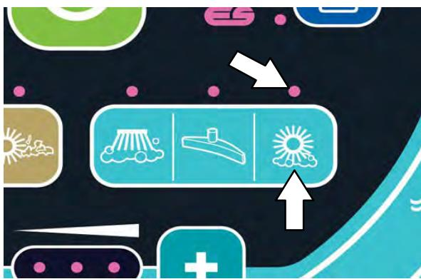
**OPOMBA:** Stroj ne more hkrati pometati in čistiti. Če za način delovanja izberete čiščenje, potem pa pritisnete koli koli gumb za pometanje, se preneha izvajati funkcija čiščenja in stroj začne izvajati funkcijo pometanja.
