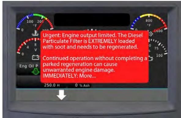
**OPOMBA:** Za ogled celotnega zaslona uporabite mehki gumb pod puščico navzdol. Za vrnitev na prejšnji zaslon uporabite mehki gumb pod puščico navzgor.
