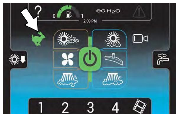
*Gumb za hitrost motorja* ugasne, kadar je motor nastavljen na majhno hitrost.
