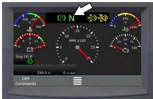
2. Pritisnite gumb za hitrost motorja, da zmanjšate hitrost motorja na hitrost prostega teka.
