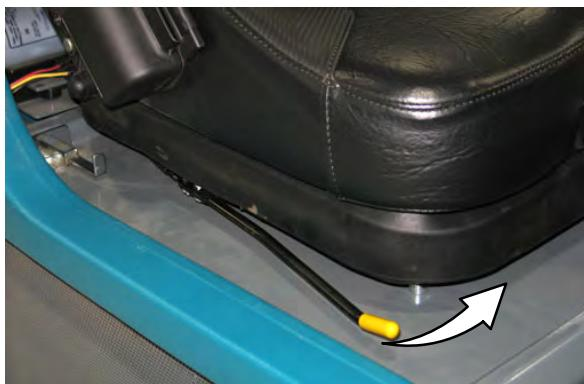
Nastavite: Potisnite ročico navznoter proti sedežu in potisnite sedež v želeni položaj. Sustite ročico, da se sedež zaskoči.
