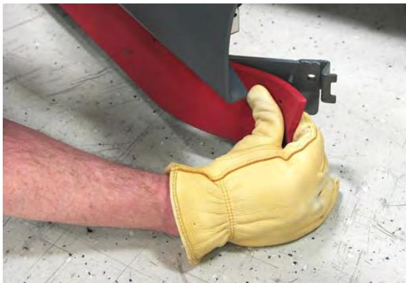
7. Znova namestite objemko stranskega otiralnika na sklop stranskega otiralnika.
