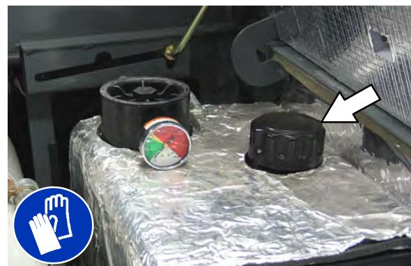
Zamenjajte filter za hidravlično tekočino vsakih 1200 ur dela ali če je merilec hidravlične posode v rumenem/rdečem področju, ko ima hidravlična tekočina v posodi okoli 32° C (90° F).
