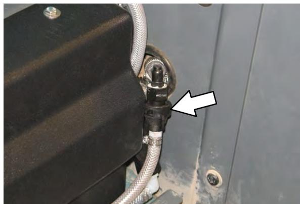
9. Pihajte zrak pod pritiskom (manj kot 344 kPa (50 psi)) v izhodno cev sistema ec-H2O.
