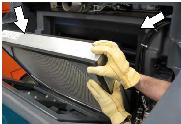
8. Po potrebi očistite ali odvrzite filter za prah. Glejte **ČIŠČENJE FILTRA ZA PRAH V KOŠU** v tem priročniku.
