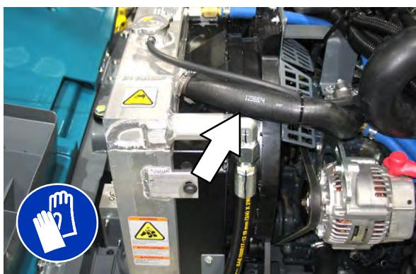
Preglejte zunanjost jedra hladilnika in rebra hidravličnega hladilca za smeti vsakih 100 ur dela. Izpihajte ali sperite ves prah skozi mrežo in rebra hladilnika v nasprotno smer običajnega toka zraka. Pri čiščenju pazite, da ne upognete hladilnih reber. Temeljito očistite, da se prah ne sprime na rebrih. Preden začnete s čiščenjem, počakajte, da se hladilnik in hladilna rebara ohladijo, da hladilnik ne poči.
