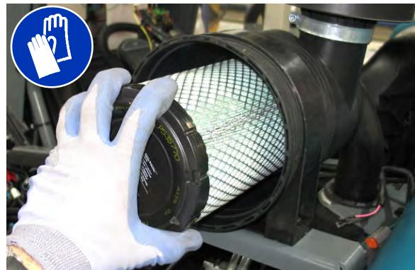
Namestite vložek filtra v ohišje filtra za zrak in ponovno namestite pokrov za prah, tako da je točka izpusta vode obrnjena navzdol.
