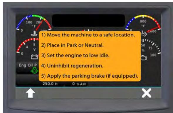
**OPOMBA:** Če so oranžni alarmi prezrti, se prikaže opozorilo o zaustavitvi, motor pa se zaustavi vsakih 5 minut, dokler se regeneracija ne konča. Če se prikaže rdeči alarm, prikazovalnik pa prikazuje »Excessive PM4« (Prekomerni PM4) (P3007) ali »Excessive PM5« (Prekomerni PM5) (P3008), upravljavec ne more več aktivirati postopka regeneracije.
