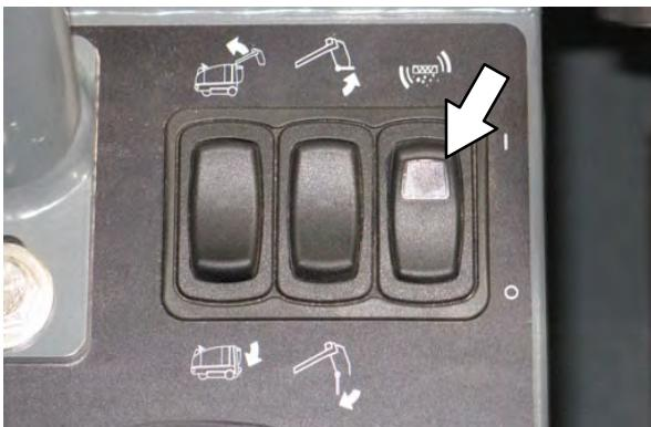
3. Ko se tresalo filtra ustavi, pritisnite in držite gornji del gumba za dvig/spust koša, da dvignete koš. Spustite gumb, ko je koš v želenem položaju.
