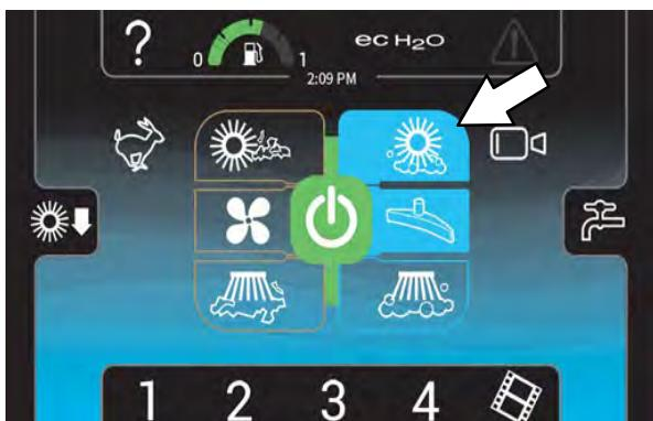
**OPOMBA:** Stroj ne more hkrati pometati in čistiti. Če za način delovanja izberete čiščenje, potem pa pritisnete koli gumb za pometanje, se preneha izvajati funkcija čiščenja in stroj začne izvajati funkcijo pometanja.
