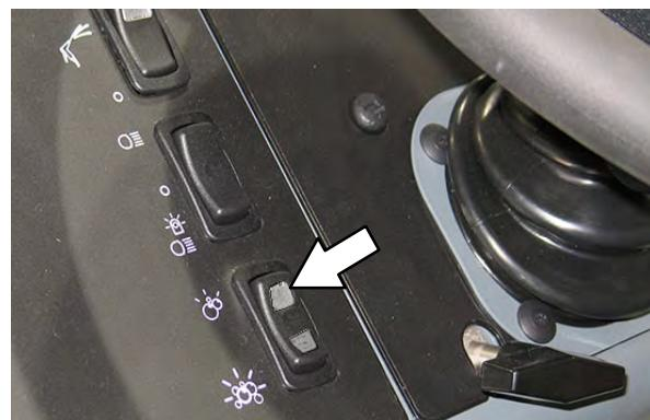
10. Pritisnite gumb 1-STEP, da izključite sistem.
