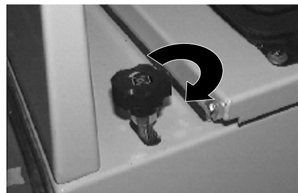
もしメインブラシパターンの両端の幅が15mm以上ちがっている時は、ブラシの駆動側の端にある傾き調整器で、傾きを直して下さい。
