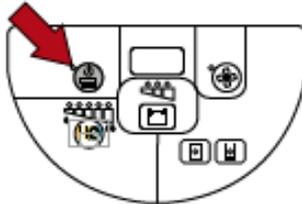
5. 如果希望预洗地面，按下吸水电机按钮以禁用吸水。
