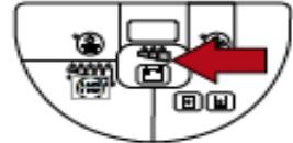
18. 要充电，将电池充电器插头插入吸水扒抬高杆旁边的插座。
