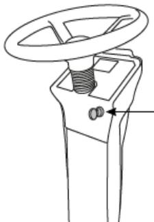
3. 按下 AUTO 或 ECO 按钮；在这两种模式下，都将启动机器的所有功能。在 ECO 模式下，机器耗电较少，运行时更静音。
