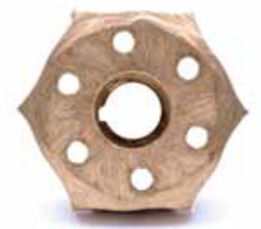
BOUCHON D'ENTRAÎNEMENT USÉ Usure accélérée due à l'absence d'orifices de drainage dans une brosse d'imitation
