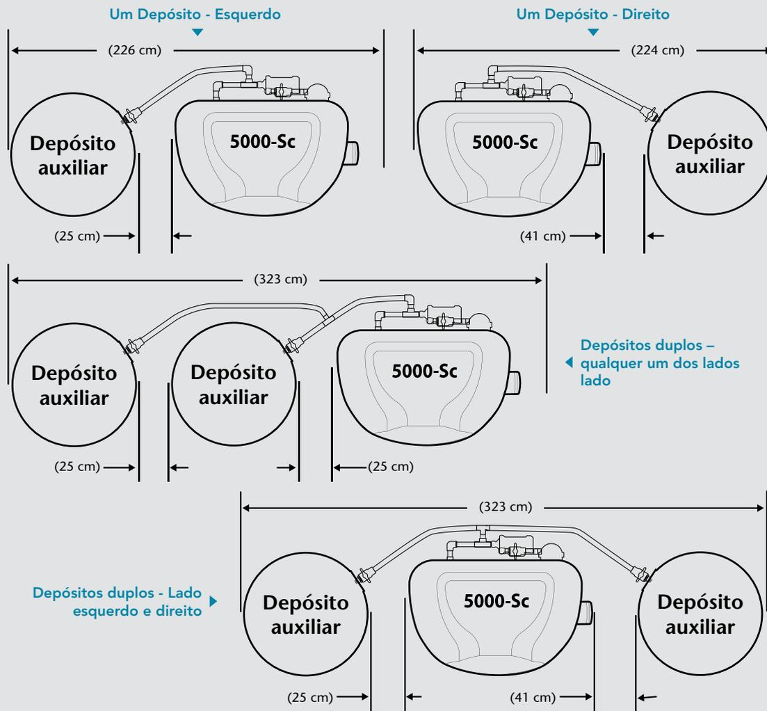
A unidade 5000-Sc e quaisquer depósitos auxiliares devem ser instalados numa superfície plana para que as bases de uma instalação completa permaneçam ao mesmo nível. É necessário um intervalo de 40,64 cm entre um depósito auxiliar e o lado direito (filtro de fluxo de entrada) do depósito para permitir o acesso ao filtro de fluxo de entrada.
