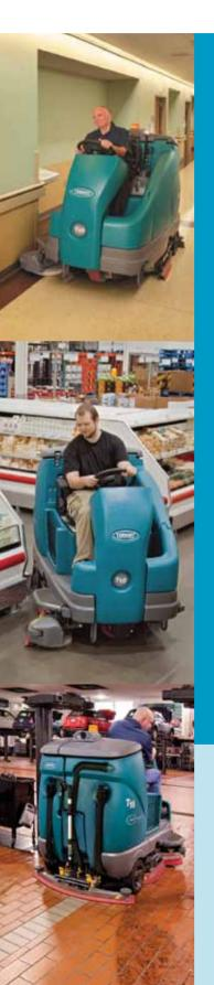
坦能电解活性水洗地技术就是把普通的自来水变成有效的清洁剂,它无需添加任何化学清洁剂。因此,电解水技术在使用时均不会对环境和使用者带来伤害。配有电解活性水洗地技术的T16在整个使用周期内节约的化学清洁剂成本将等同于整台机器的成本。电解活性水洗地技术:
