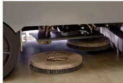
Amplie a faixa de limpeza de 1020 mm para até 1370mm. Melhore a margem de limpeza e maximize a produtividade com a escova de varrição lateral opcional.
