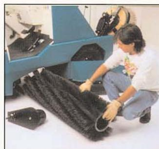
換側刷和主刷只需數分鐘，無須工具。停工時間短，清掃更有效率。
