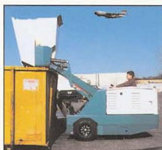
舉高傾倒設計使垃圾箱可自地面升到1,830公釐來傾倒垃圾。垃圾箱可前伸510公釐，提高傾倒的速度和效率。
