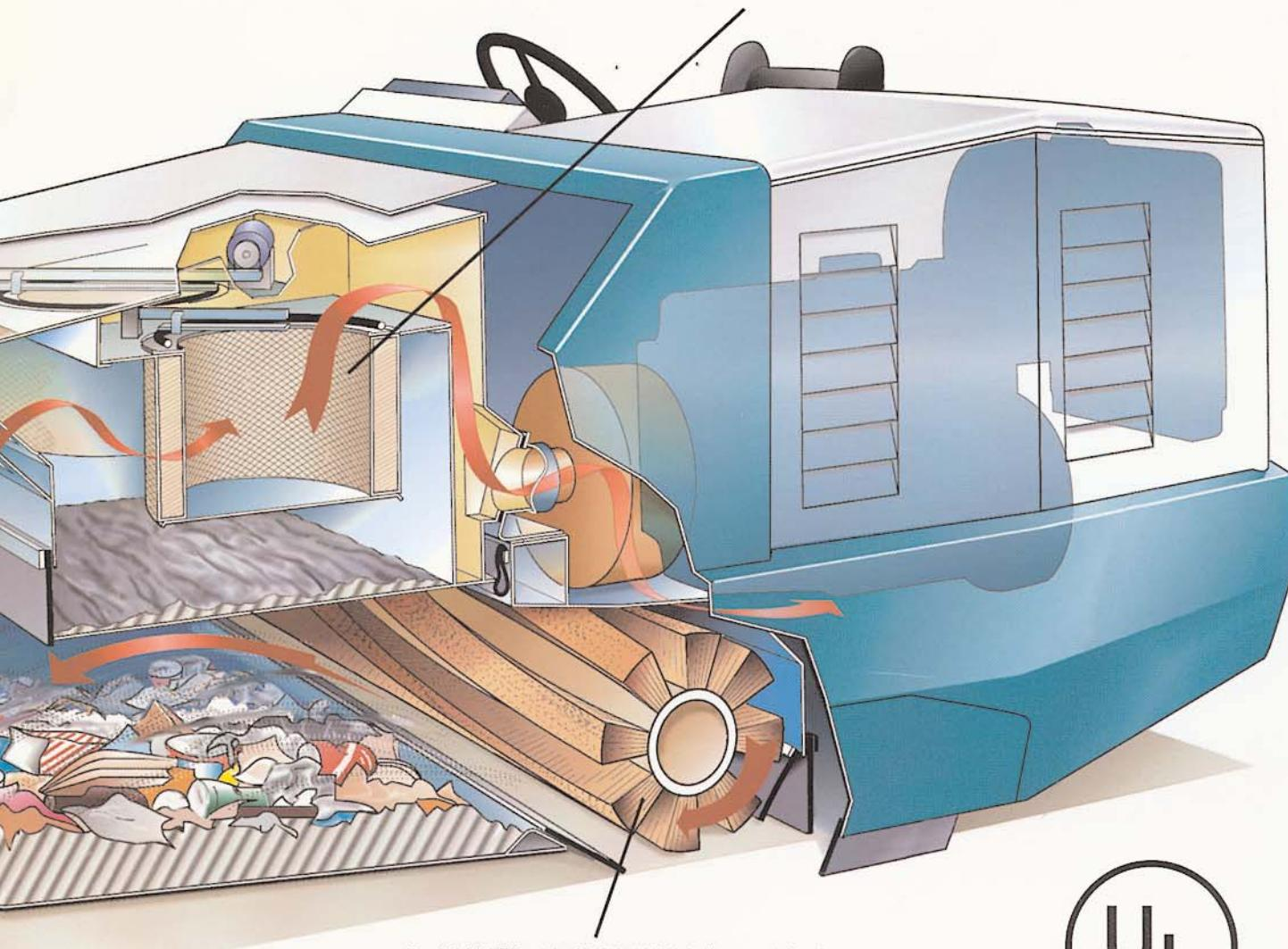
二段式轉速™可調節掃刷的速度，以達到完全清掃各種的污物—包括輕的廢物。
