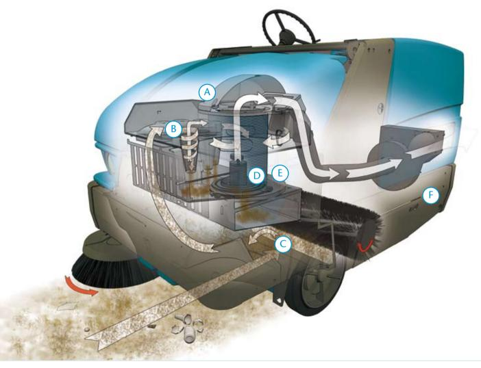
Thermo-Sentry™ 探测到垃圾箱的温度上 升时,通过提醒和关闭气流来确保操作 人员安全。
