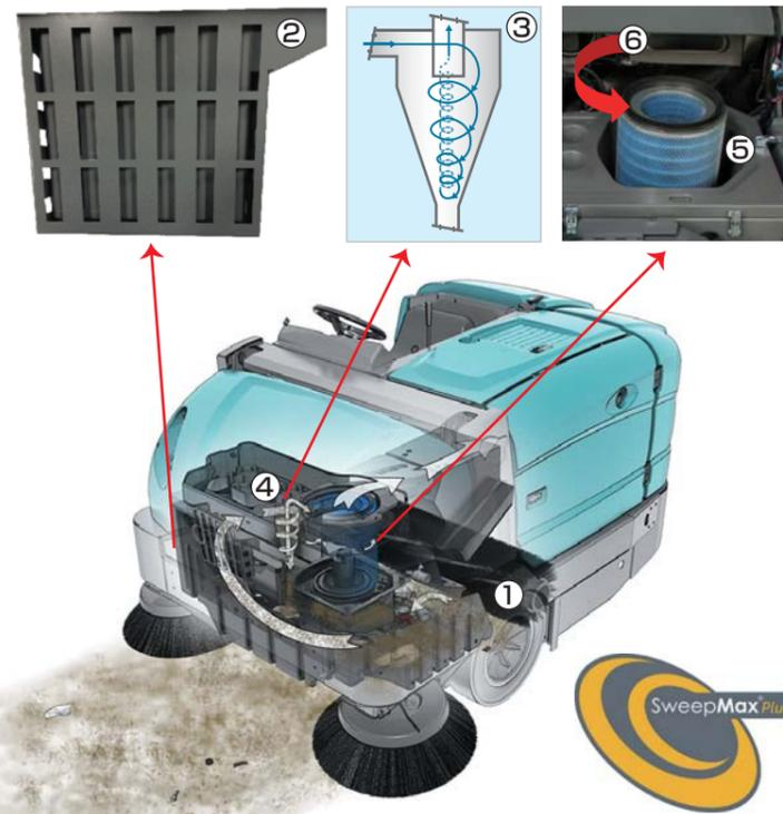
フィルターを前方配置。ホッパーとの距離を短くし、シェーク・マックスによって効率的にチリやホコリをホッパーに落とす事で長時間の使用でもダストコントロール能力を持続
