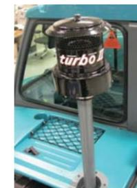
上部取込口にあるファインの遠心力でホコリ、虫を除き、エンジンエアフィルターの負担を軽減
