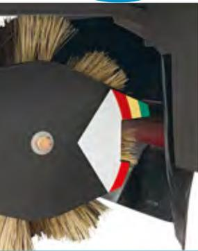
独有的按颜色编码刷头磨损指示可以正确地进行刷头设置。
