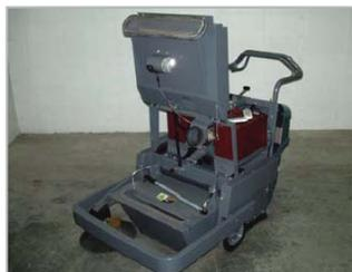
スチール製全周バンパーで、ダメージを最小限に抑えます。粉塵の多い工場でも使用でき、多様な現場に対応します。
