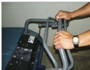
押すと前進し、引くと後進するハンドルは、簡単な工具を使用して高さが3段階に調節できます。
