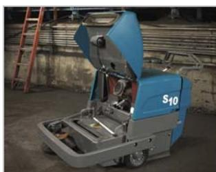
標準装備のサーモ・セントリー™システムで、ホッパー内に火気を感じると、バキュームファンを停止し、空気も遮断します。
