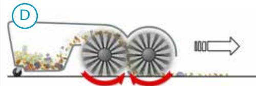
Die TwinMax Technologie wurde entwickelt, um verschiedenste Böden im Innen- und Außenbereich zu kehren. Dadurch erhalten Sie maximale Vielseitigkeit, immer und überall.
