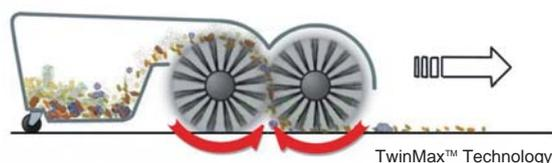
2本のメインブラシが互いに逆回転し、ダイレクトとオーバースローの両方の効果で、ホコリ・ゴミをホッパーに掃込むツインマックス機構搭載
