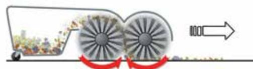
Die TwinMax Technologie wurde entwickelt, um verschiedenste Böden im Innen- und Außenbereich zu kehren. Dadurch erhalten Sie maximale Vielseitigkeit, immer und überall.
